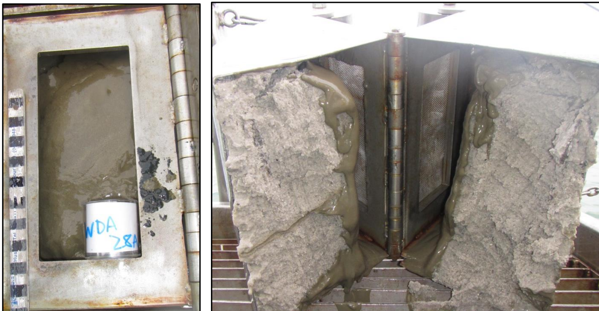
Abb. 2: Sedimentprobe entnommen aus Entnahmetrichter im Arbeitsgebiet WDA. Draufsicht (links) und Profil (rechts). Gut zu erkennen ist eine etwa 5 cm mächtige Schlickschicht abgelagert über feinsandigem Material.
