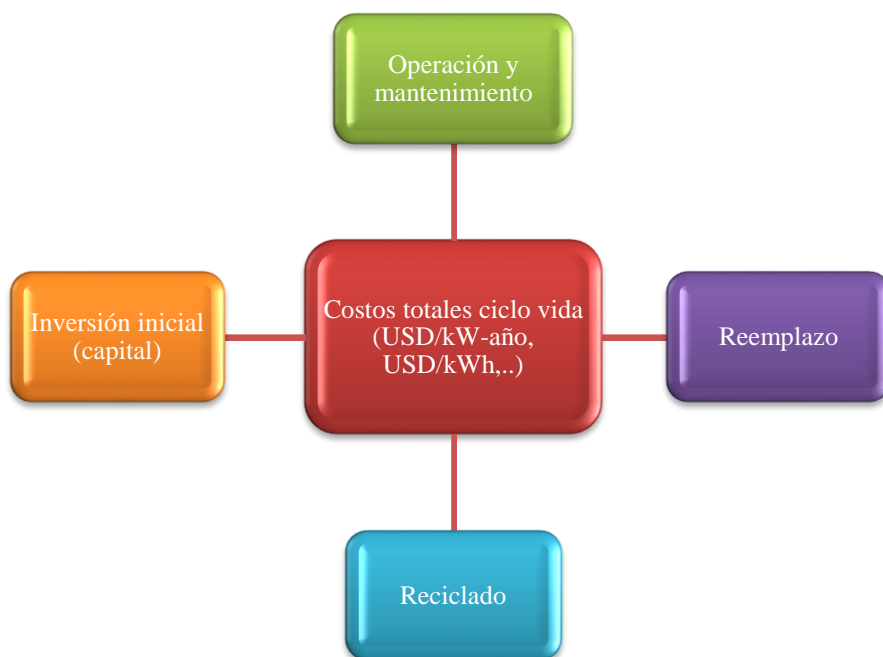
Figura 5. Costos asociados al ciclo de vida de los sistemas de almacenamiento de energía. (Atienza Serna, 2011)
