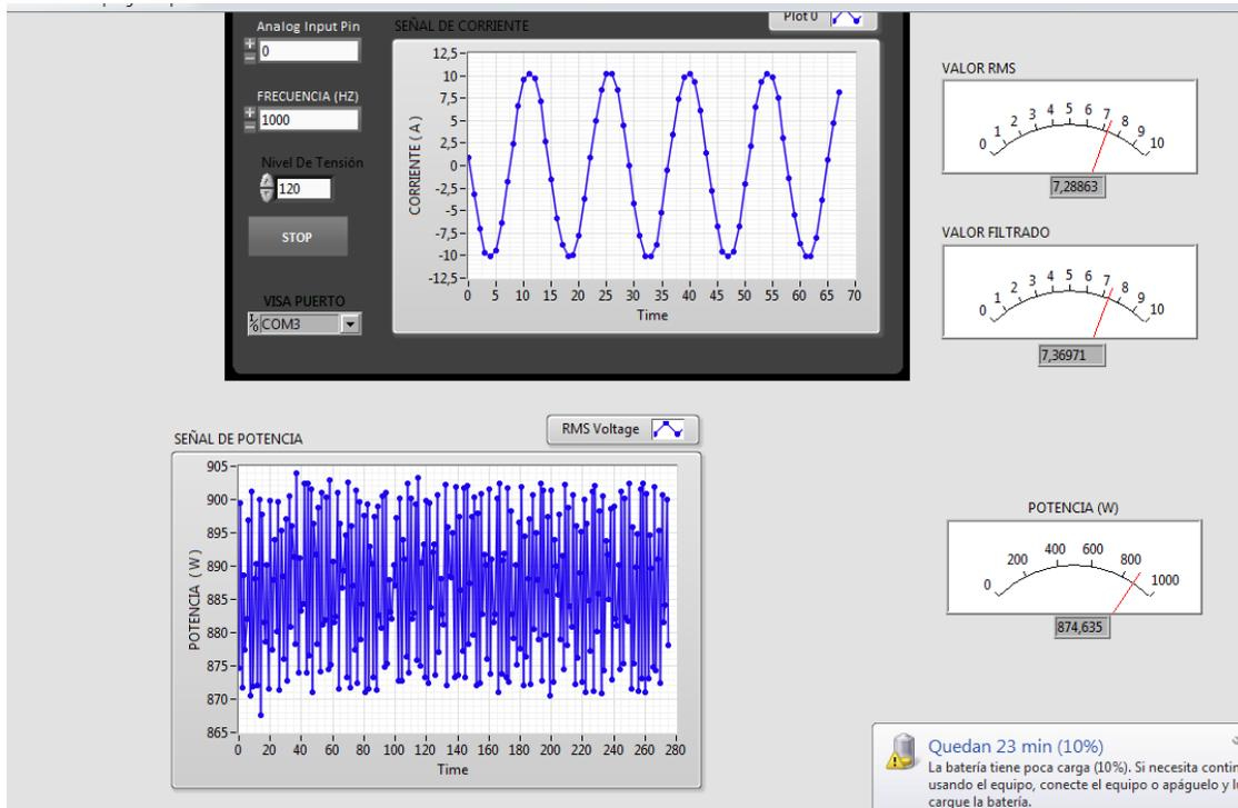
Figura. 21. Energía registrada en 30 minutos en Plancha
