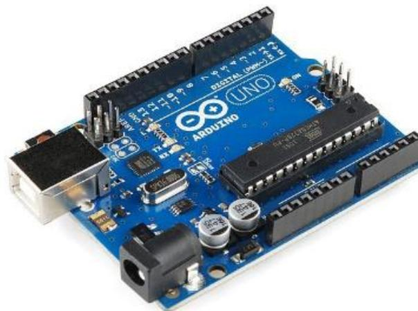
Figura 9. Placa de Arduino Uno.
