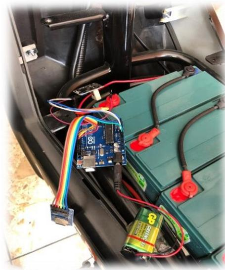
*Figura 2. 17 Alimentación del circuito de adquisición (2*
