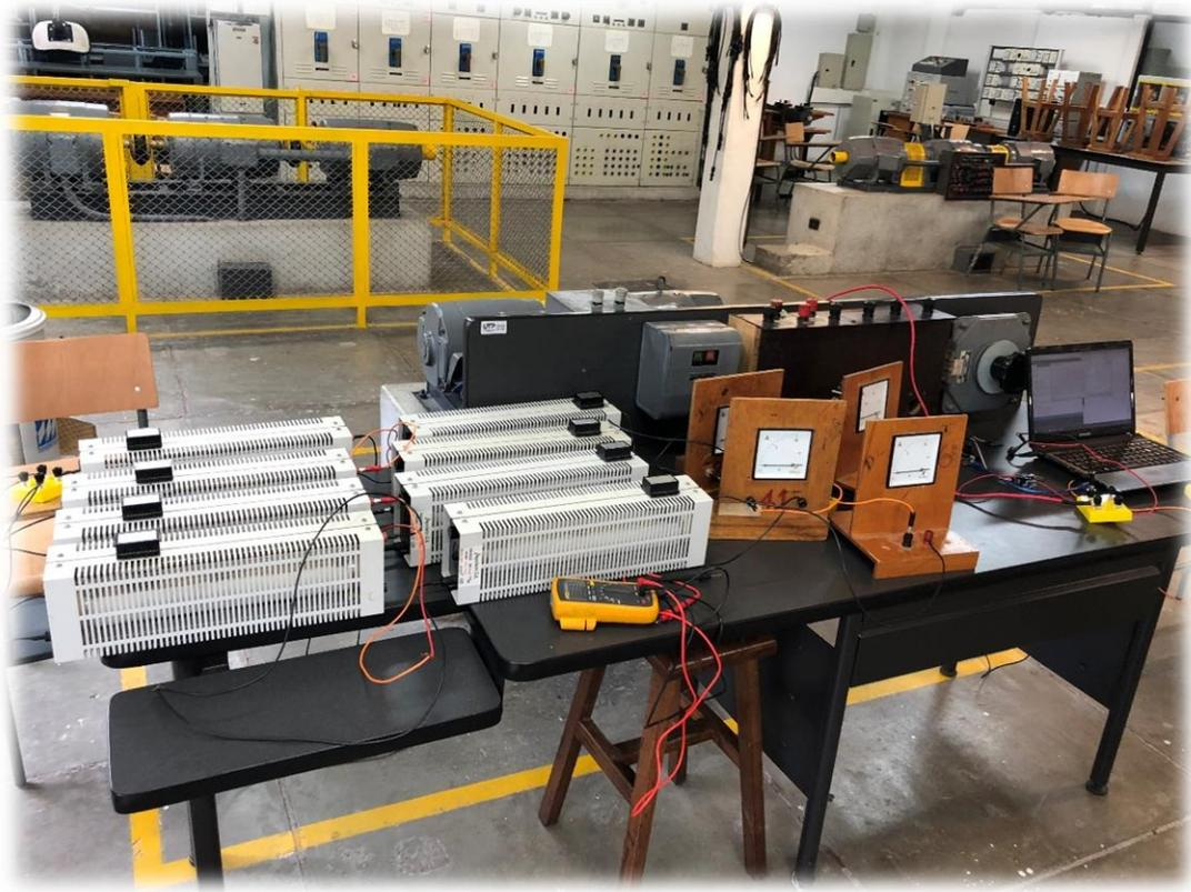
*Figura 2. 11 Montaje circuito de prueba sensor WCS1800.*
