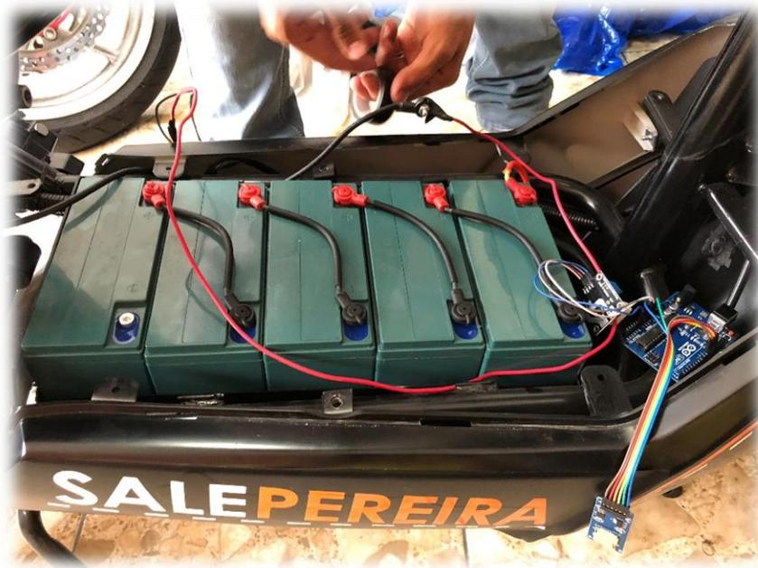
*Figura 2. 16 Alimentación del circuito de adquisición.*
