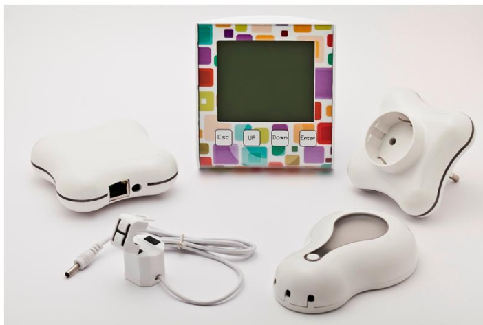
Figura 4.2. Equipamentos (concentrador, monitor, tomada inteligente, transmissor e sensor),(Martins, 2013).
