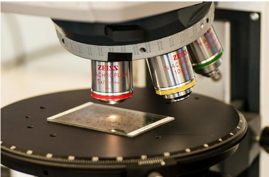
Fig. 53\_Análise ao microscópio da textura (tamanho, arranjo e proporção) cristalina de uma espécie pétreia, normalizado pela EN 12047, entre outras
