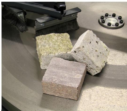
**Fig. 49\_(esq.)** Máquina de ensaio de abrasão e desgaste (tipo Böhme)
