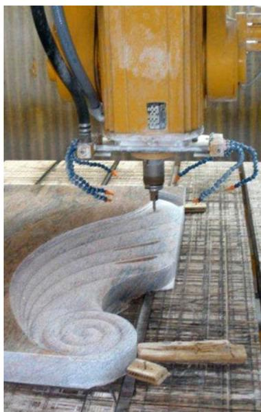
**Fig. 206**\_(dto.) Corte CNC (fresa) a esculpir detalhe numa placa de granito
