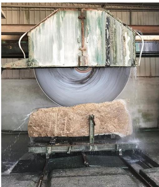
**Fig. 205**\_(esq.) Corte de bloco de granito por serra circular diamantada
