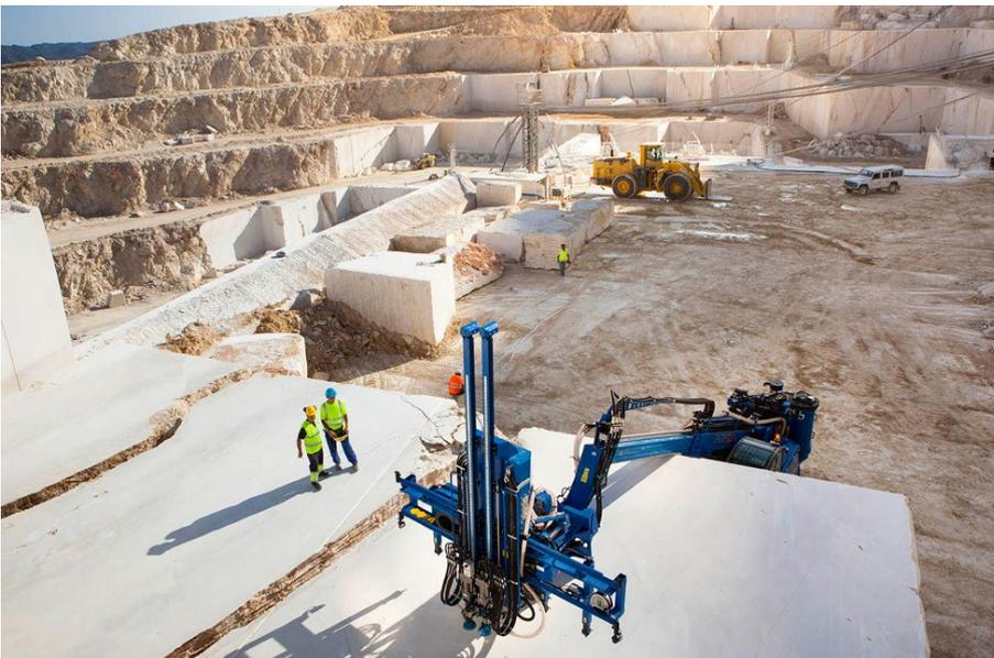
**Fig. 201** Pedreira de Leventina, Espanha. A máquina de perfuração vertical (veículo azul) prepara a próxima linha de corte (outras duas linhas de corte podem ser vista à esquerda, linhas de fractura a castanho)
