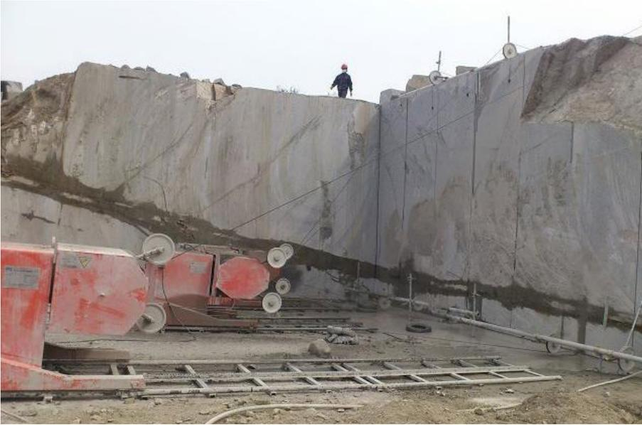
**Fig. 200** Máquina de forte de fio diamantado. Conjugada com múltiplas roldanas e extensões, o fio pode ser usado para cortar qualquer plano de rocha em qualquer sentido
