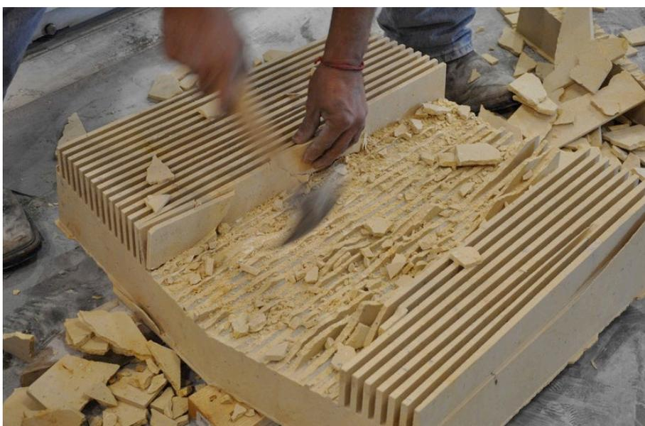
Fig. 271\_Processo produtivo dos elementos discretos onde após serragem automatizada, as lâminas geradas são partidas manualmente para obter a textura lascada final
