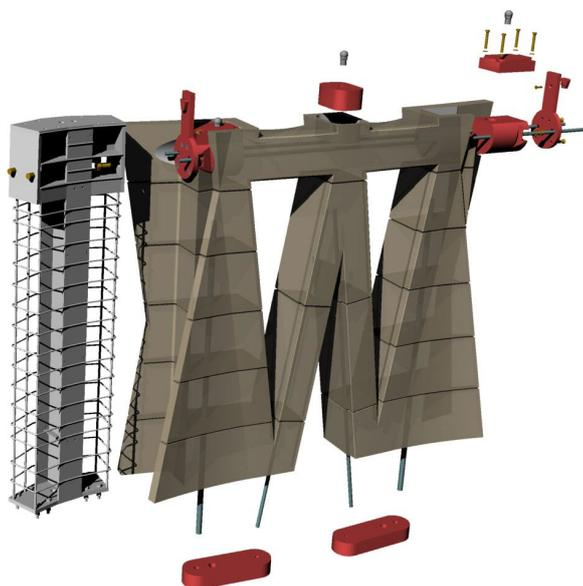
**Fig. 245** Módulo do composto pétreo (pedra reforçada por cabos de aço horizontal e verticalmente) que constituem as torres centrais
