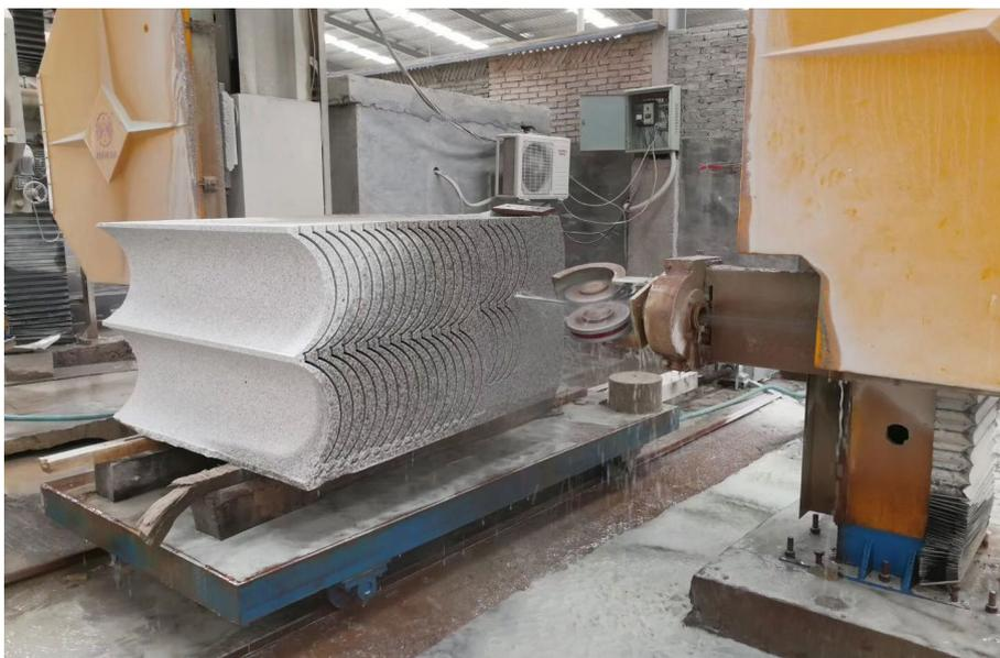
**Fig. 207\_Corte CNC de fio diamantado.** Possibilidade de cortar superfícies curvas para alto rendimento da placa
