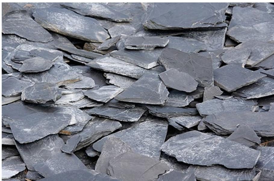
**Fig. 27**\_Ardósia, devido ao alto grau de xistosidade, tende a destacar-se facilmente em lâminas
