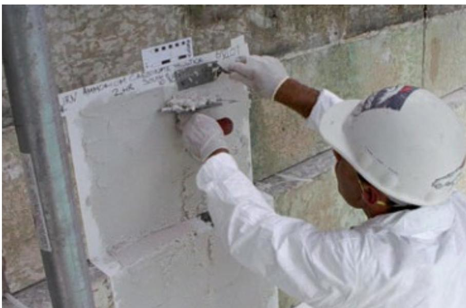
**Fig. 60**\_Teste de limpeza química em fachada pétrea
