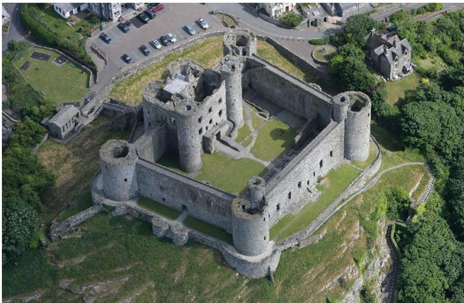
**Fig. 155** Castelo de Harlech, séc. XII. Apesar de em ruínas, a sua lógica de construção e desenho é legível: muralha espessa, implantação em ponto alto, reforço dos cantos
