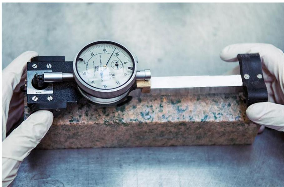
**Fig. 47**\_Medição de dilatação térmica ou higroscópica linear
