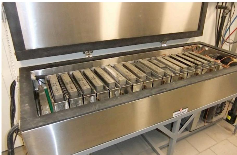
**Fig. 51** Máquina refrigeradora para ensaio de ciclo de gelo e degelo, normalizado por EN 12326-2, entre outras
