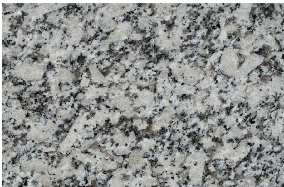
**Fig. 13**\_Granito Cinza Corumbá. A textura granular permite a leitura dos diversos minerais que o compõem
