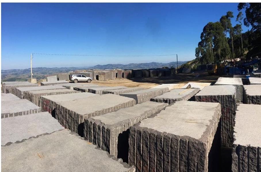
**Fig. 204**\_Terreiro de armazenamento dos blocos de granito. Os vincos indicam a utilização da técnica de pré-corte
