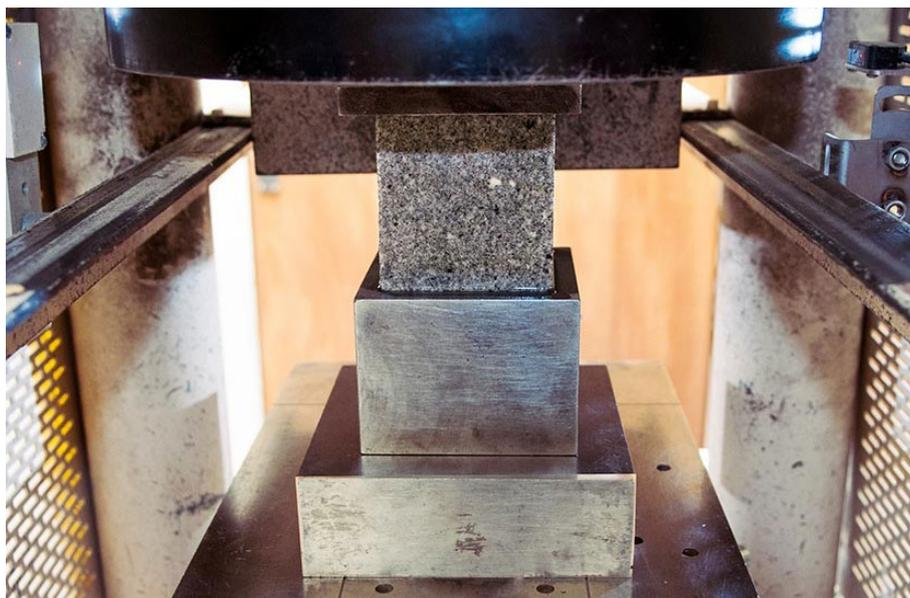
**Fig. 45**\_Ensaio de resistência à compressão num provete cúbico
