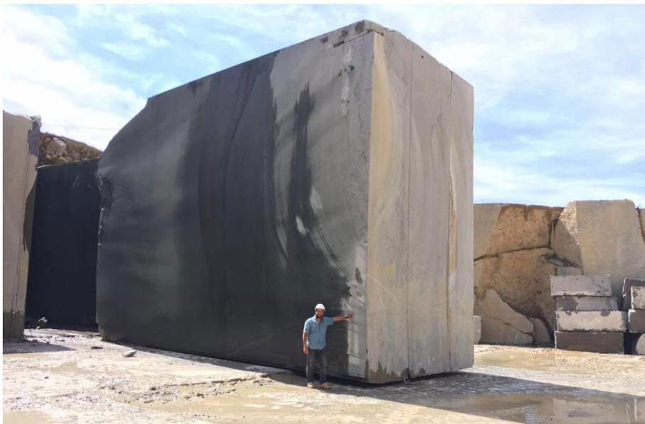
**Fig. 203**\_Bancada de granito extraída antes da divisão em blocos. Destaque por fio diamantado devido à superfície lisa e os padrões que apresenta
