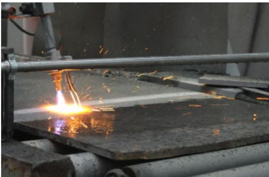
**Fig. 208\_Flamejadora** a tratar a superfície de uma placa de granito (mudança cromática)
