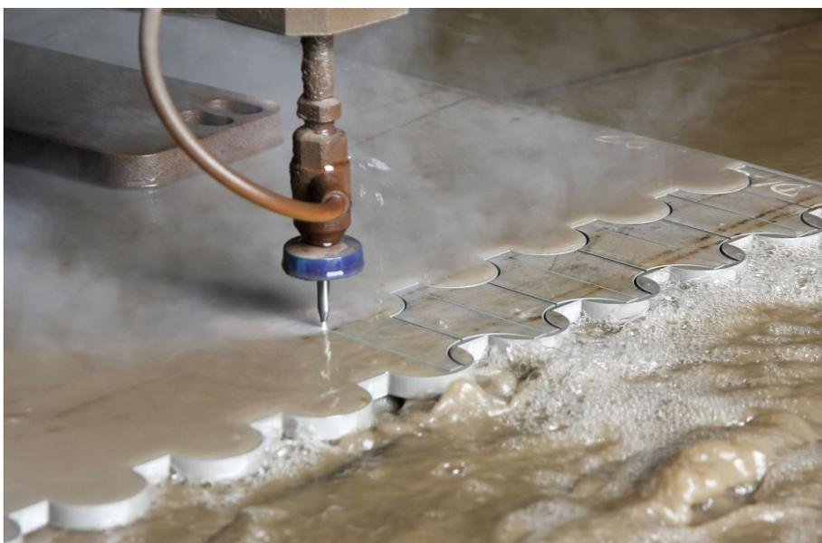
**Fig. 233** Corte CNC por jacto de água. A evolução da tecnologia permite cortar elementos complexos com grande eficiência
