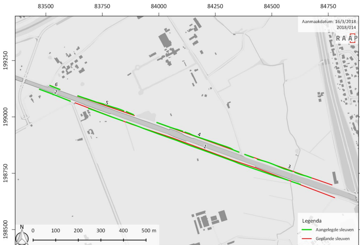
figuur 11 Overzicht van de geplande versus de werkelijk aangelegde sleuven voor de zone aan Manewaarde, sleuven 1 tot en met 6 (schaal: 1:10 000 ; bron: AGIV, 2017b).
