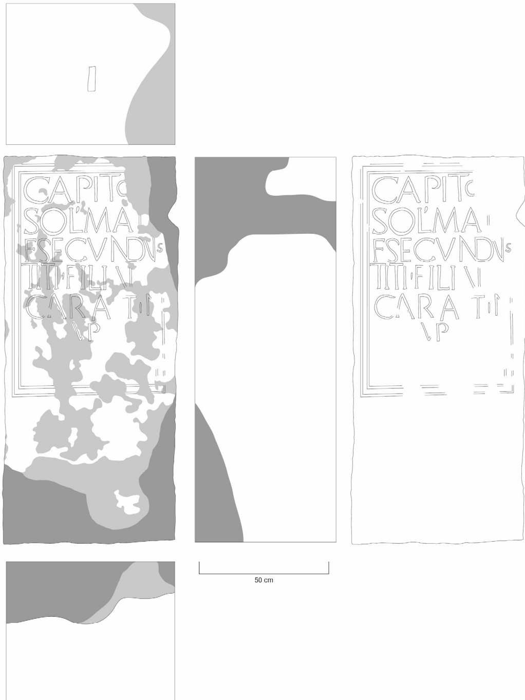
Afb. 43. Het grafmonument in diverse aanzichten met daarop aangegeven de beschadigingen. De oppervlakkige beschadigingen in lichtgrijs en zwaardere en diepere beschadigingen in donkergrijs. Rechts de inscriptie weergegeven zonder de beschadigingen.
