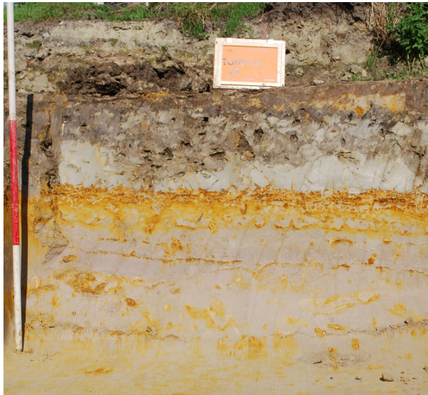
Afb. 14. De bodemopbouw in het noorden van het plangebied. Het gevlekte kleipakket (net onder het oranje fotobord) bevat veel grind en kiezels.
