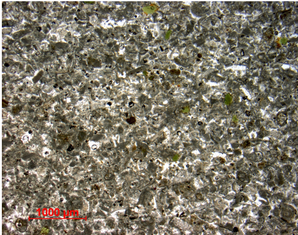
Afb. 41. Microscopische opname van slijpplaatje fijnkorrelige 37.001. Fijnkorrelige peloidenrijke bioklastische grainstone met glauconietkorrels (groen). Calcietcement is hoofdzakelijk syntaxiaal ontwikkeld rond kleine fragmenten van echinodermen. Doorvallend gepolariseerd licht zonder gekruiste nicols.
