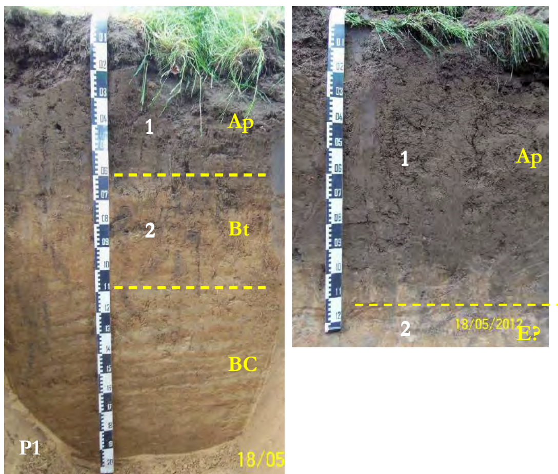
Afbeelding 7: Bodemprofielen opgenomen door AS in 2012 (Smeets 2012). Links profiel 1 (plateau) en rechts profiel 2 (belling). Op het plateau (P1) lijkt sprake te zijn van een Bt-horizont met een dikte van circa 50 cm met daaronder een gebandeerde BC-horizont. De top van eenheid 2 (Bt-horizont) is sterk gebioturbeerd/ antropogeen geroerd. Op de belling (P2) is de Ap-horizont circa 100 cm dik. De top van eenheid 2 (E-horizont volgens Studiebureau Archeologie) is sterk gebioturbeerd. De gele markeringen/aanduidingen zijn van zijde van Condor.
