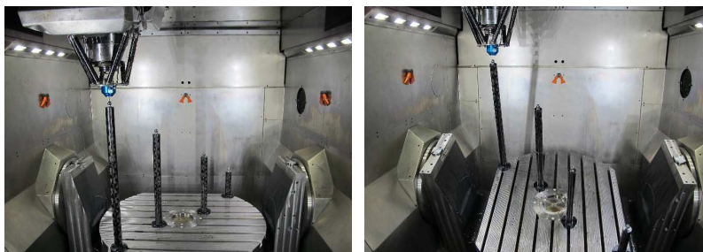
Obr. 3: Termostabilní modulární rám.
