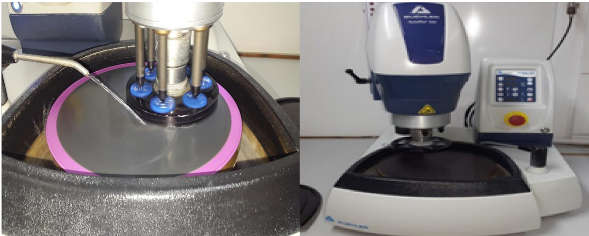
Slika 13.3: Naprava za avtomatsko pripravo obrusov Buhler EcoMet 250
