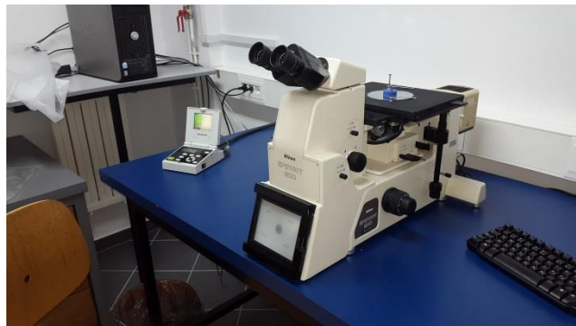
Slika 14.3: Svetlobni mikroskop, uporabljen pri karakterizaciji mikrostrukture
