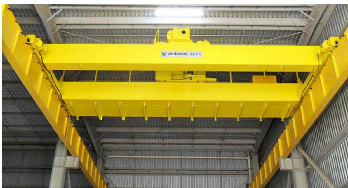
Figura 03 - Ponte Rolante Dupla Viga
