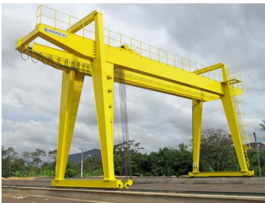
Figura 05 - Pórtico Dupla Viga com Duplo Balanço
