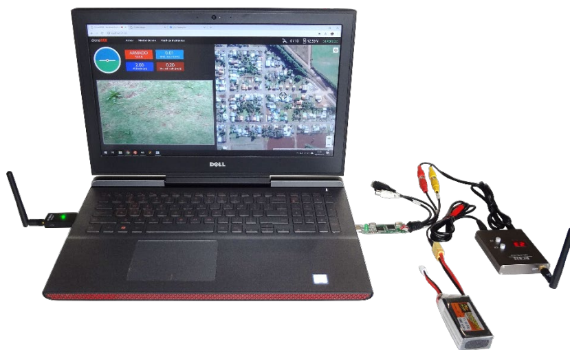
Figura 48 – Estação de Controle Terrestre
