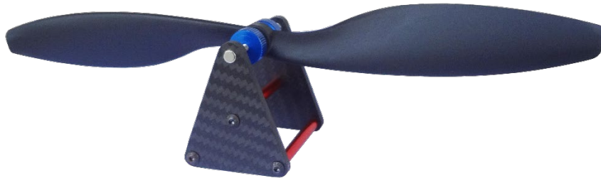
Figura 51 – Balanceamento de hélice sendo verificado
