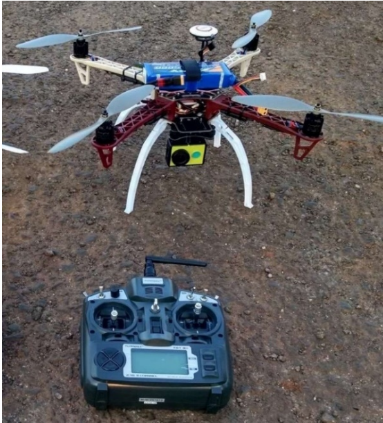
Figura 22 – Drone e seu rádio transmissor
