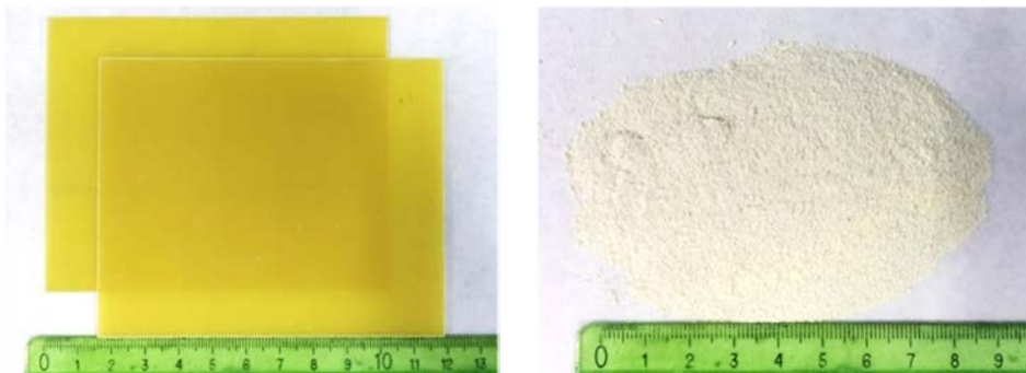
Figura 2-2. Placas de circuito impreso originales y trituradas.
