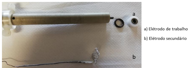
Figura 3.4: Eléctrodo de trabalho e eléctrodo secundário utilizados nos ensaios electroquímicos de avaliação dos fluxos iónicos
