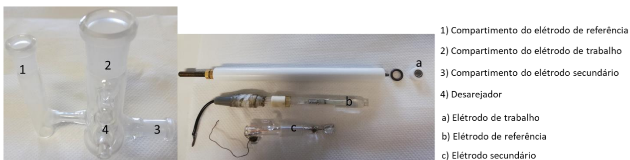
Figura 3.1: Célula eletroquímica utilizada para a síntese e caracterização do PEDOT:PSS e os seus respetivos elétrodos.
