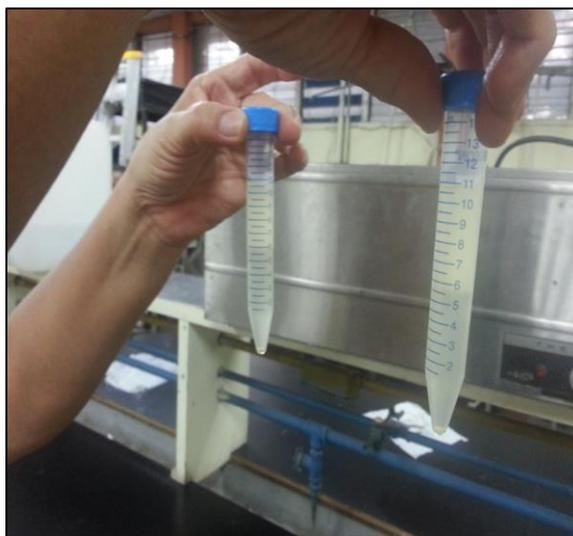
Figura 2.12 Resultado de muestras sometidas a centrifugación para evaluar la posibilidad de una clarificación extra. A la izquierda, se observa la centrifuga y a la derecha, el jugo clarificado ya centrifugado.
