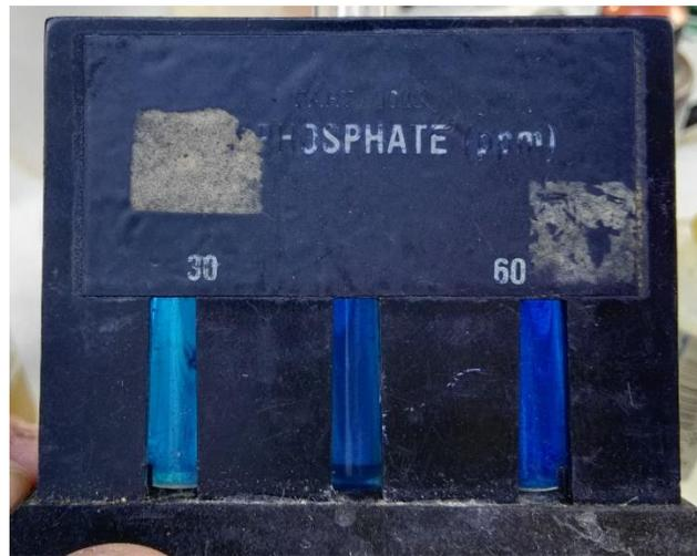
Figura 3.7 Comparación de colores para determinación de cantidad de Fosfatos en pulpa de mango.
