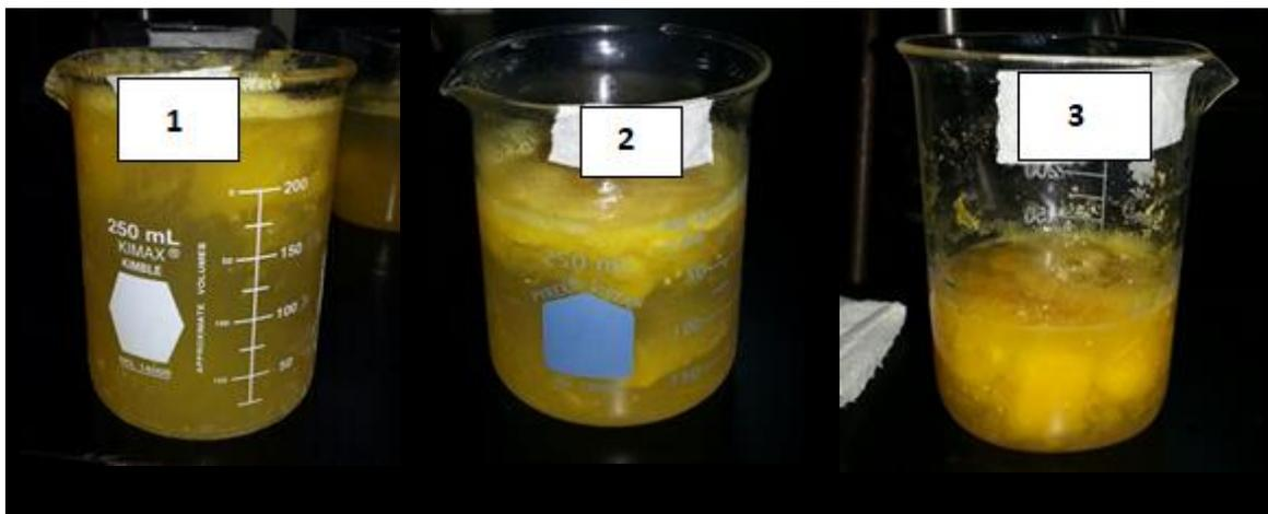
Figura 2.13 Pruebas de clarificado de jugo de mango con poliacrilamida con volumen total de, 250 ml, 200 ml y 150 ml de izquierda a derecha.
