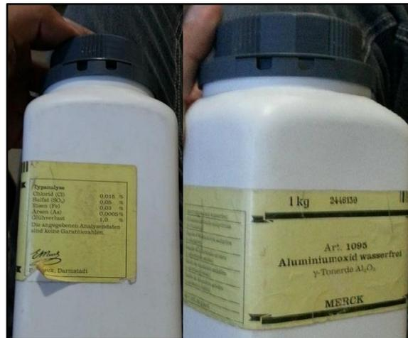
Figura 1.12 Óxido de aluminio calidad reactivo con pureza de 98% utilizado en la investigación para la clarificación del jugo de mango.
