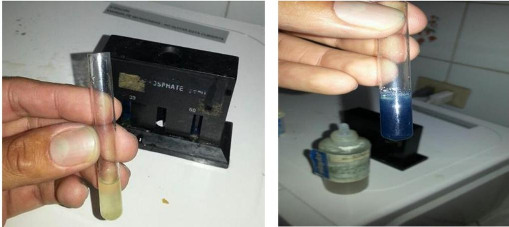
Figura 3.6 Preparación de muestras jugo de mango clarificado y formación de color azul para comparación
