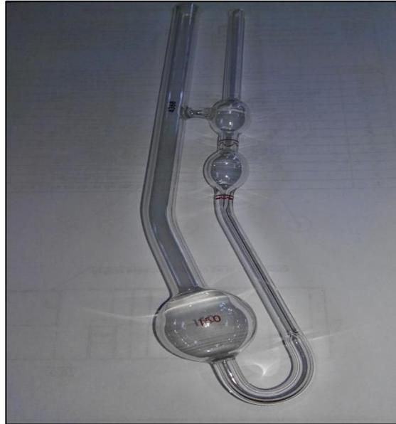
Figura 3.4 Viscosímetro utilizado en las pruebas de laboratorio marca CANNON FENSKE modelo 4368. Laboratorio de Ingeniería Química FIA-UES
