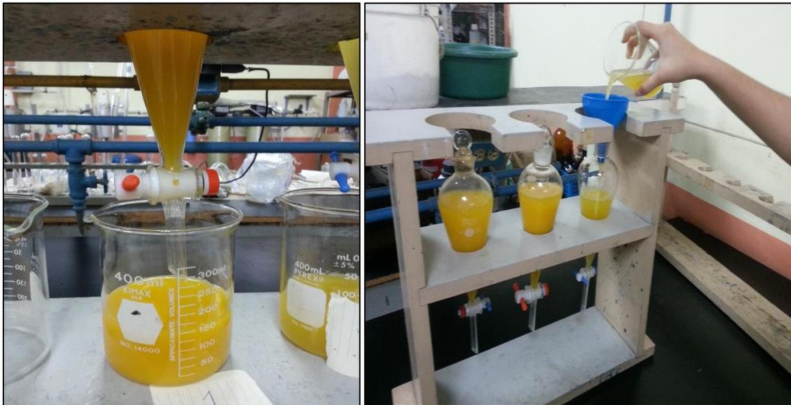
Figura 2.7 Ensayos de Laboratorio con Alumbre para clarificación de jugo de mango, utilizando ampollas de separación.
