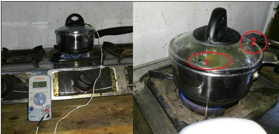
Figura 3.17 Ensayo de laboratorio para obtención del jugo de mango concentrado a partir de jugo clarificado de mango.
