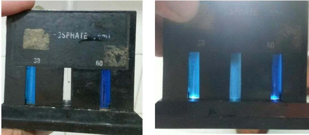
Figura 3.8 Comparación de colores para determinación de cantidad de Fosfatos en jugo de mango clarificado
