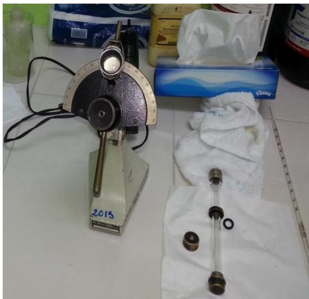
Figura 1.16 Polarímetro de laboratorio para mediciones de rotación óptica Marca DR. STEEG AND REUTERS, modelo SR-6, utilizado en laboratorio de Facultad de Química y Farmacia - UES
