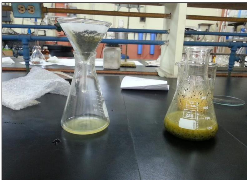
Figura 2.8 Ensayo de laboratorio utilizando Carbón Activado para clarificación de jugo de mango.
