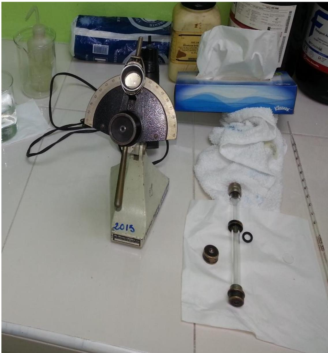
Figura C.2. Polarímetro marca DR. STEEG AND REUTERS, modelo SR-6 utilizado en Laboratorio de Química y Farmacia – UES.
