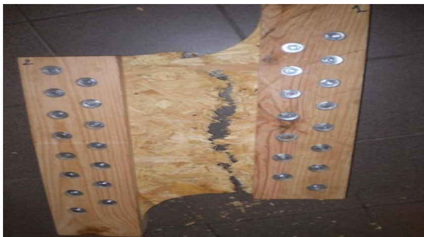
FIG. 5- Exemple d'une éprouvette rompue en cisaillement de voile
