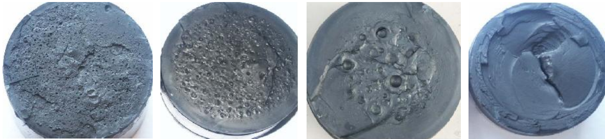
Figure 2 : Faciès de rupture des éprouvettes pancake : h = 2.5, 5, 10 et 25\text{mm} .
