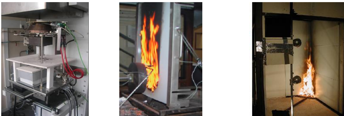
FIG. 1 – Moyens d'essai en réaction au feu employés : cône calorimètre standard, Medium Burning Item et Single Burning Item (LNE)
