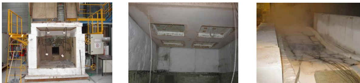
FIG. 2 –Panneaux sandwich : four F, mise en place et essai en cours (Efectis France)
