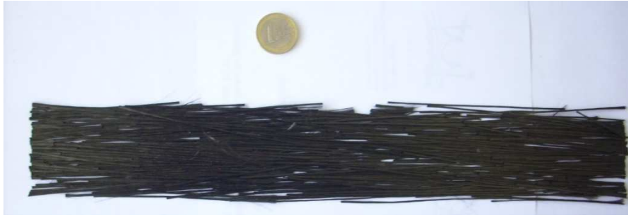
FIG. 2 - Exemple de bande obtenue après défilage/réalignement (fibres T300 3K)
