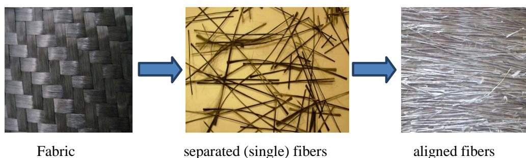
FIG. 1 - Etapes du procédé de défilage réalignement
