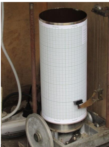
Kuva 12. Virtaamamuutoksia piirtävä anturi Teeressuonojalla.
