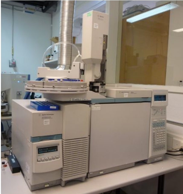
Kuva 17. Työssä käytetty kaasukromatografi-massaspektrometri.
