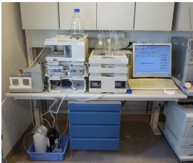
Kuva 18. Työssä käytetty UV/VIS-nestekromatografi ja fraktionkerääjä.
