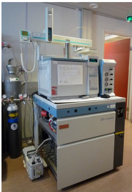
Kuva 19. Työssä käytetty kaasukromatografi-poltto-isotooppisuhdemassaspektrometri.
