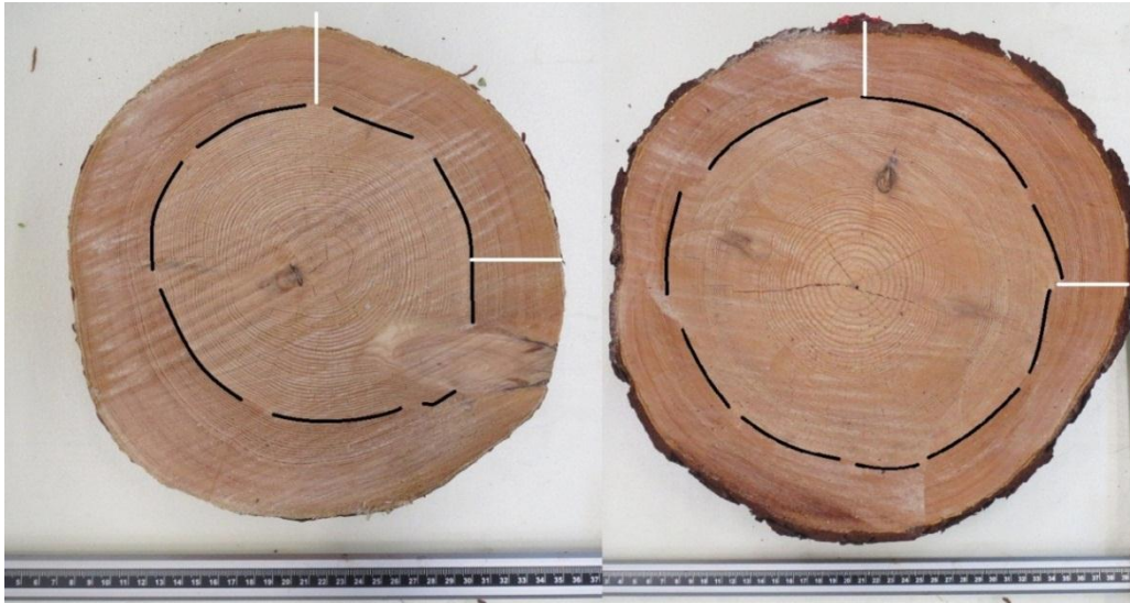
Kuva 1. Näyttekiekot männystä 50 % (vas.) ja 7,5 % suhteellisilta korkeuksilta. Sydän- ja mantopuun raja on korostettu mustalla värillä. Kuviin piirretyt valkoiset viivat vastaavat todellisuudessa viiden senttimetrin mittaa ja ne on piirretty pohjois- etelä- ja itä- länsisuunnassa.
