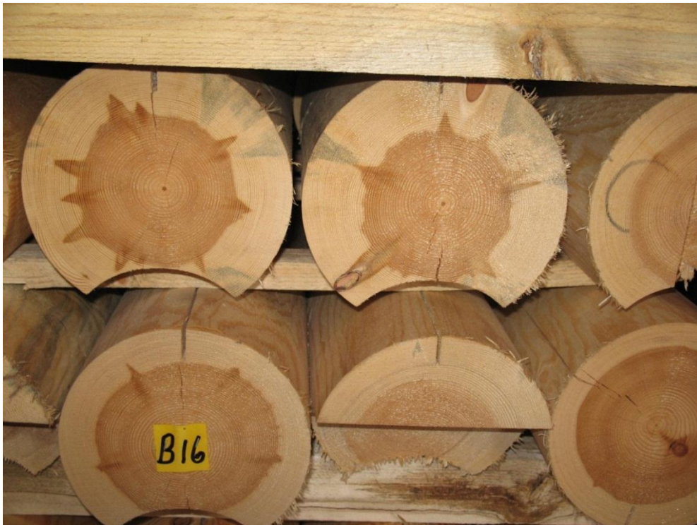
Kuva 2. Esimerkkikuva erilaisista männyn manto- ja sydänpuun rajapinnoista. Poikkileikkauspinnat osoittavat, että männyn sydän- ja mantopuun raja voi noudattaa melko tarkasti puun vaippapinnan muotoa, mutta olla myös epätasainen ja esimerkiksi piparin muotoinen. Kuva: Metla/Martti Venäläinen.
