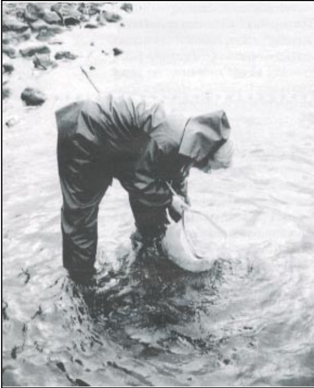
Kuva 1. Käsihaavi soveltuu hyvin kovapohjaisten järvenrantojen näytteenottoon.
