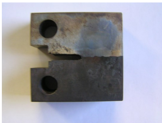
Obr. 29: Rozhraní základní materiál – I. návarová vrstva na C(T) tělese po provedené autoklávové zkoušce
