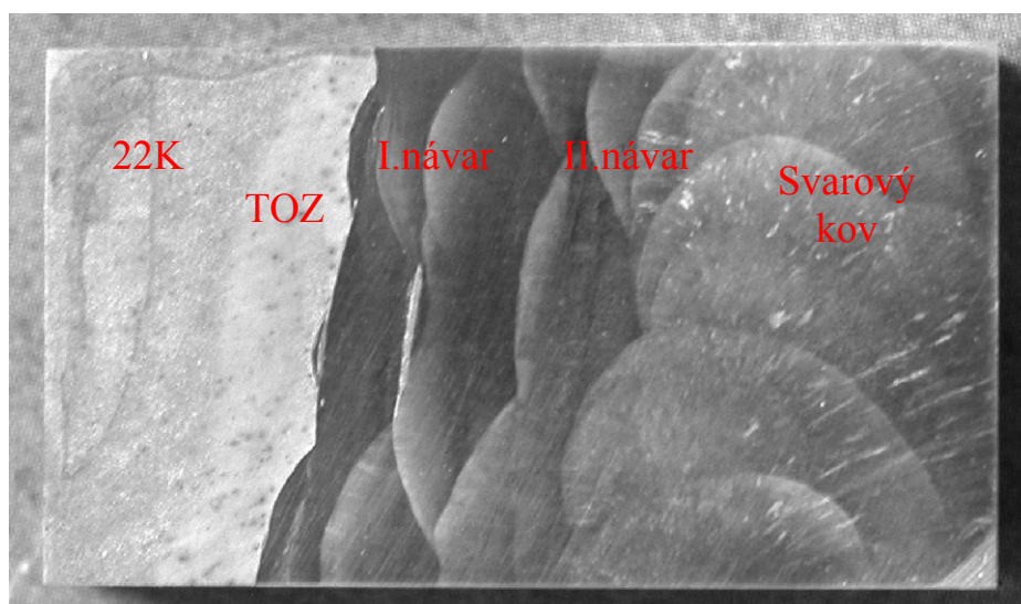
Obr. 18: Celkový pohled na heterogenní svarový spoj ruské provenience
