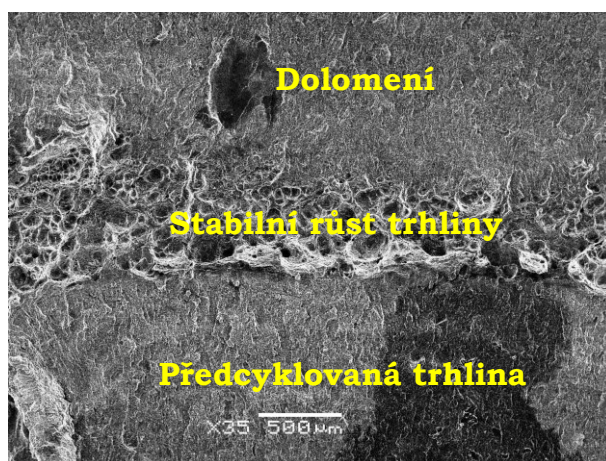
Obr. 28: Pohled na lomovou plochu porušeného C(T) tělesa na řádkovacím elektronovém mikroskopu JEOL, zv. 35x
