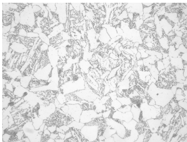
Obr. 43: Mikrostruktura základního materiálu vítkovického HSS – popuštěný bainit + ferit
