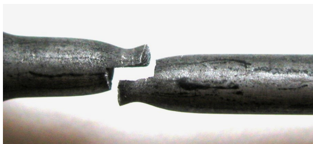
Obr. 26: Zkušební těleso po autoklávové zkoušce a před měřením kontrakce
