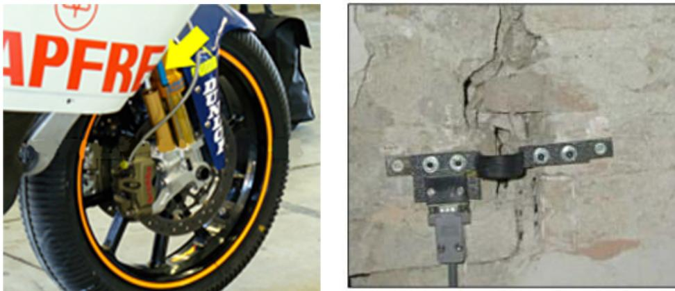
Figura 2.6: Esempi di applicazioni estensimetri
