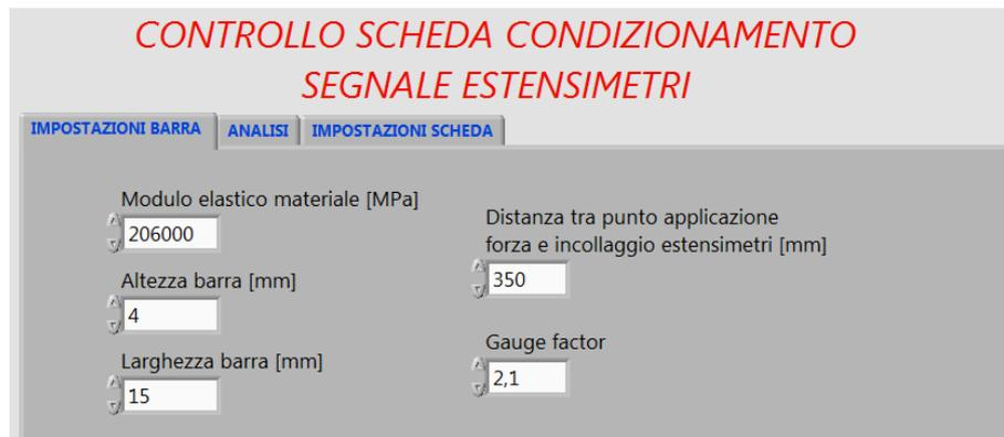
Figura 5.1: Scheda di impostazione valori relativi alla barra e agli estensimetri impiegati
