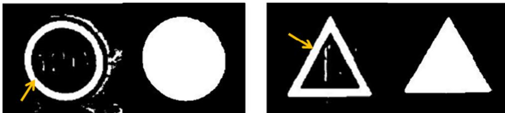
**Figura 24** – *Clusters* fechados, com “buracos” no seu interior (identificados com a seta amarela) e respectivo resultado obtido depois de efectuado processo de preenchimento dos “buracos”.
