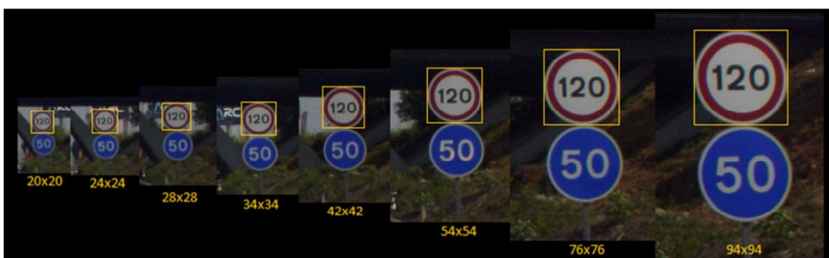
**Figura 19** – Sinais captados numa sequência consecutiva de *frames* com a indicação do rectângulo do *cluster* delimitador do sinal e das suas dimensões (em *pixels*) em cada fragmento de *frame*.
