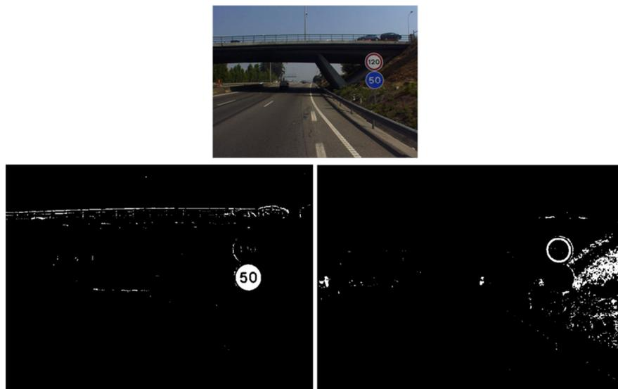
**Figura 17** – Nesta figura é apresentado o mesmo *frame* que o apresentado na Figura 16 (em cima ao centro) e as segmentações realizadas a esse *frame* para a cor azul (à esquerda em baixo) e para a cor vermelha (à direita em baixo) com os mesmos parâmetros para a componente Tonalidade (H) que os usados na Figura 16, mas com restrição dos parâmetros de Saturação (S) e Valor (V).
