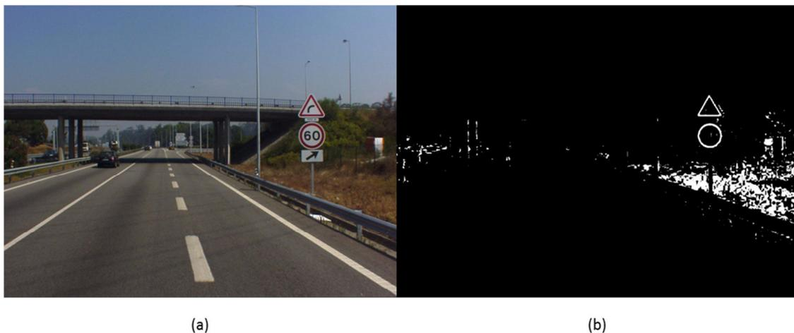
**Figura 12** – (a) *frame* extraído do vídeo original. (b) imagem binária resultante do processo de segmentação por cor descrito no subcapítulo 4.1.1.
