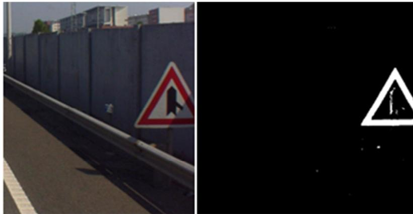
**Figura 21** – Exemplo de um sinal/*cluster* rejeitado devido a estar em contacto com os limites da imagem.
