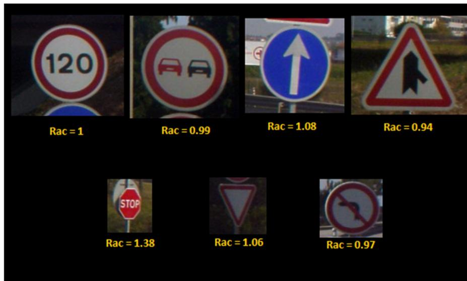
**Figura 20** – Fragmentos de *frames* nos quais estão presentes sinais, com a indicação do respectivo rácio altura-comprimento (Rac) do rectângulo do cluster para cada situação.
