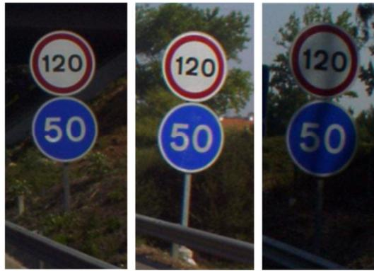
**Figura 27** – Exemplo da influência que diferentes condições de iluminação têm na coloração da sinalização.
