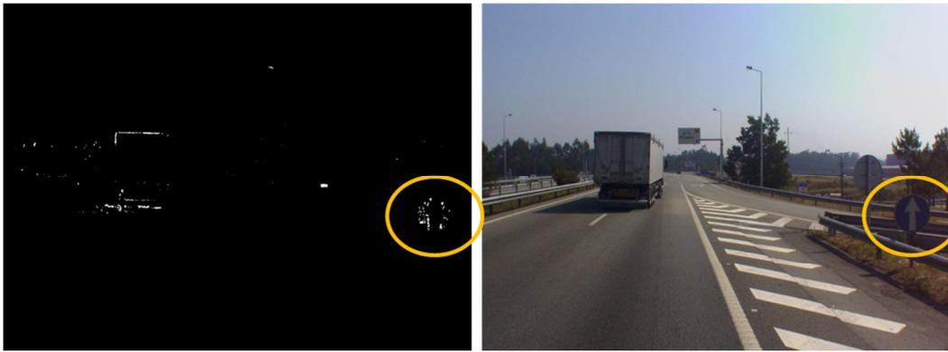
**Figura 25** – Sinalização de cor azul não detectada devido às condições de iluminação (contra luz).
