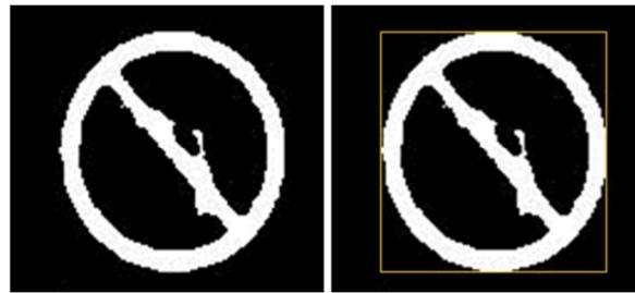
**Figura 18** – *Cluster* criado a partir de um *frame* (à esquerda). O mesmo *cluster* com o rectângulo delimitador de dimensões mínimas utilizado nos diferentes critérios usados para aceitar ou rejeitar *clusters* (à direita).
