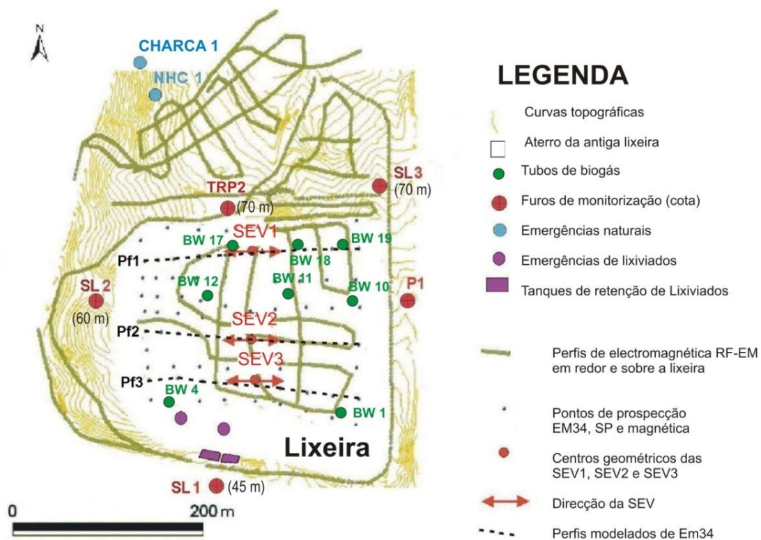
Fig. 4.10 – Levantamentos geofísicos realizados em redor e sobre o aterro da lixeira selada das Gaeiras e levantamento hidrogeológico da área (Costa et al., 2002). Perfis electromagnéticos de RF-EM localizados em redor e sobre o aterro e localização dos 81 pontos de EM34, SP e de prospecção magnética efectuados sobre o aterro. A localização das SEVs 1, 2 e 3 está indicada, bem como a sua direcção. Inventário hidrogeológico (SL1, SL2, SL3 e P1 são os piezómetros de monitorização perfurados após a selagem da lixeira; o TRP2 é um furo de monitorização que não foi amostrado). A cota da boca dos piezómetros encontra-se representada (m). É referenciada a localização dos perfis Pf1, Pf2, Pf3 e Pf4 (adaptado de Ramalho et al., 2012). BW# corresponde à localização dos tubos de biogás utilizados neste trabalho referidos na Tabela 4.3.
