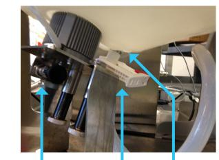
Levitronix® Motor Clamp
