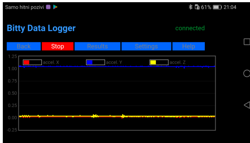
Slika 30. Mjerenje ubrzanja Y osi micro:bita
