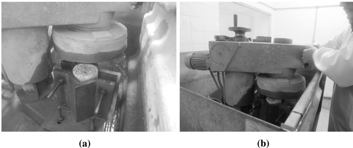
**Figura 4.9 - Retificação dos provetes de betão: a - pormenor de encaixe do provete e b - processo de retificação.**
