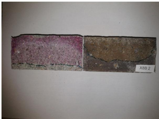
**Figura 5.12 - Profundidade de carbonatação (esquerda) e profundidade de penetração de cloretos (direita), ciclo B, após o ensaio de migração.**
