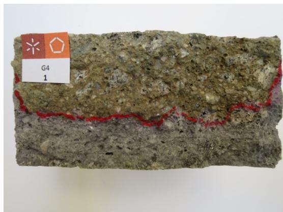
**Figura 4.23 - Identificação da profundidade de penetração de cloretos através da aspersão de solução de  $\text{AgNO}_3$ : zona inferior do provete (esbranquiçada) - presença de cloretos livres e zona superior do provete (castanha clara) - ausência de cloretos livres.**
