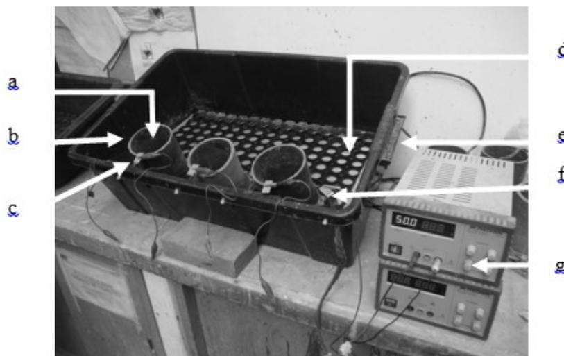
**Figura 4.4 - Configuração do ensaio de migração de acordo com a especificação LNEC (E463, 2004): a - solução anódica, b - manga de borracha, c - ânodo, d - solução catódica, e - reservatório catódico, f - cátodo e g - fonte de alimentação.**
