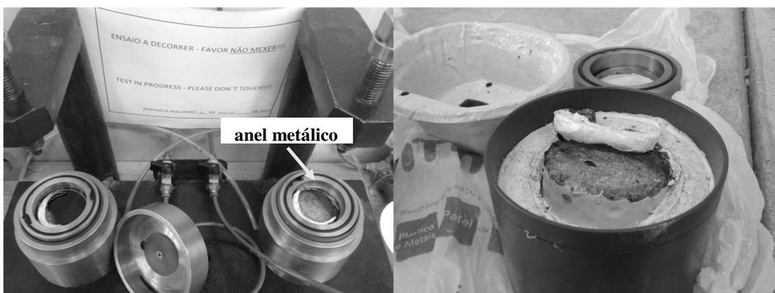
**Figura 5.11 - Ensaio de permeabilidade aos líquidos finalizado: a - células de ensaio abertas após finalização do ensaio e b - pormenor da borracha rasgada e do provete deslocado da posição inicial.**
