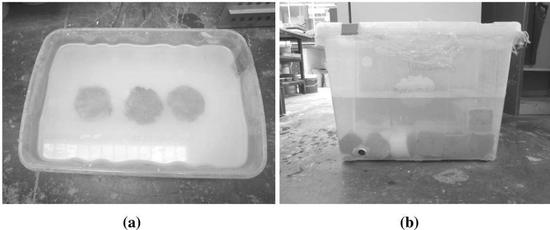
**Figura 4.5 - Ensaio de difusão de cloretos por imersão desenvolvido com base na especificação LNEC (E390, 1993): a - imersão em solução saturada de  $\text{Ca}(\text{OH})_2$  durante fase de pré-condicionamento e b - provetes imersos em solução de NaCl.**
