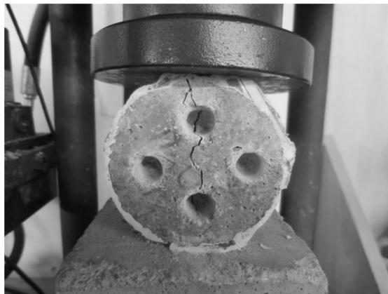
**Figura 4.12 - Provetes rompido por compressão diametral após término do ensaio de difusão de cloretos por imersão e retirada de amostras em pó.**
