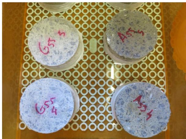
Figura 6.29 - Provete B-CV40-0,50 durante o ensaio de absorção capilar: A - FC1 (direita) e G - FR1 (esquerda).
