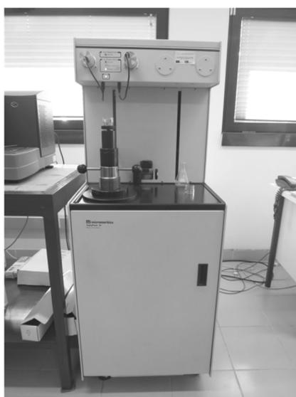
**Figura 4.29 - Porosímetro de mercúrio AUTO PORE IV utilizado durante a pesquisa.**
