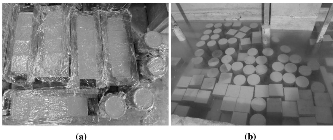
**Figura 3.7 - Preparação do provete: a - moldes preenchidos e preparados para repousar durante 24 horas em câmara húmida e b - provetes em cura húmida.**
