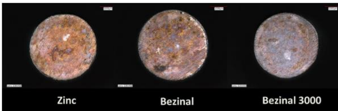
Figura 36 Sección transversal de un cable de acero con Zinc, Bezinal® (Zn, 5% Al), y Bezinal 3000® (Zn, 10% Al, <1% Mg) [44]
