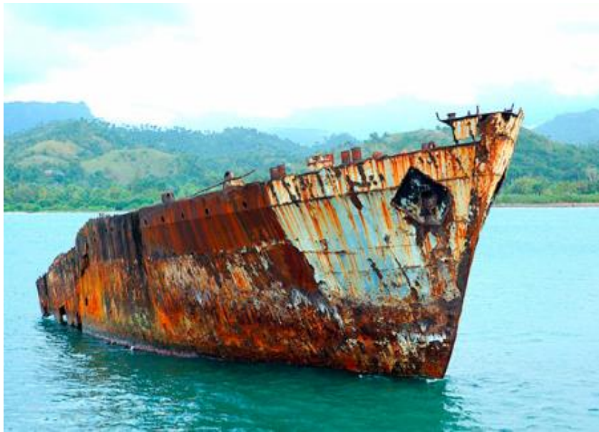
Figura 2 Ejemplo de corrosión uniforme [10]
