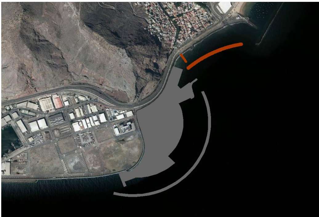
Ilustración 28. Alternativa 0. Configuración inicial del puerto (color gris) y obras de protección frente a la costa de San Andrés (color naranja)
