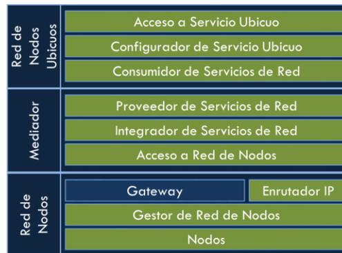
**Figura 21 Componentes implementados del segmento IoT.**
