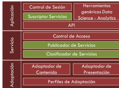
**Figura 23 Componentes implementados del segmento utilidad.**
