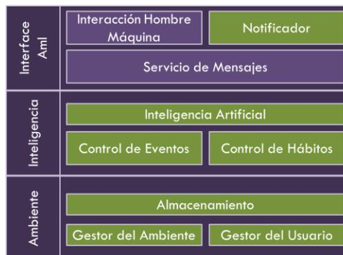
**Figura 22 Componentes implementados del segmento AmI.**
