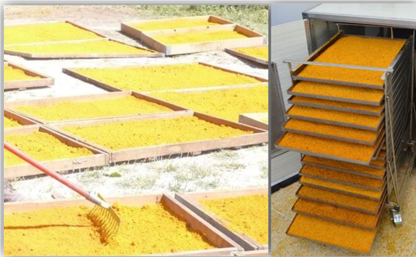
Figura 5. Izquierda: Desecación natural de polen de abeja. Derecha: Desecación en cámara con control de temperatura. (Fuente: Corona Apicultores).
