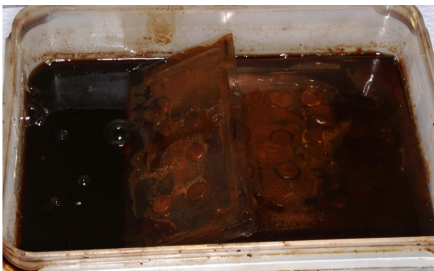
Figura 5. Discos (grupos de estudo) submersos em solução corante
