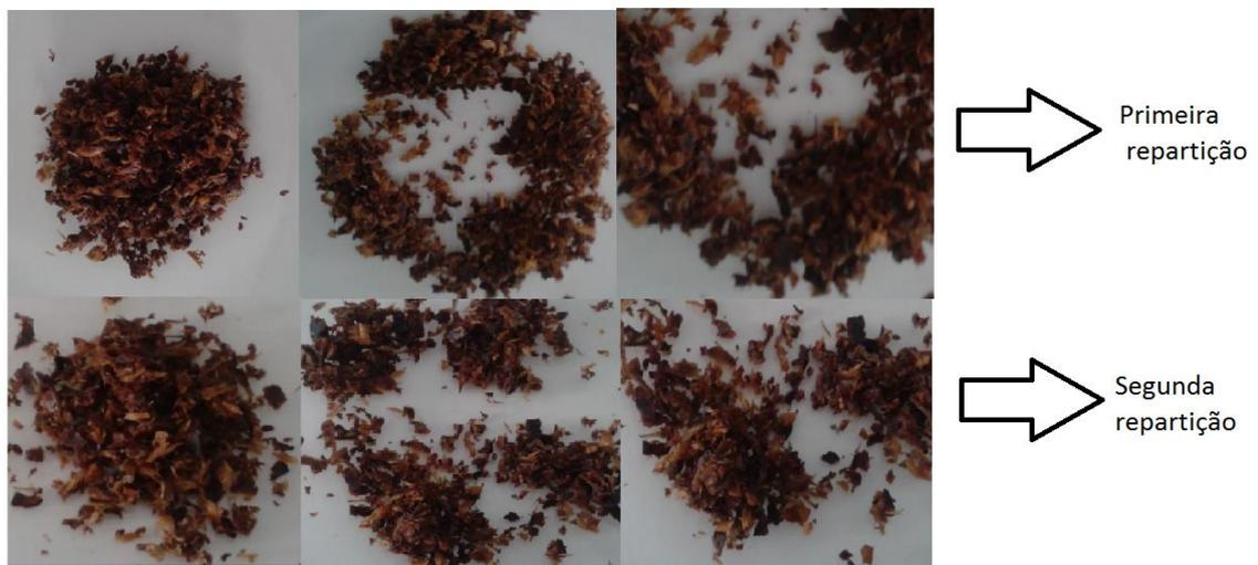
Figura A.1- Técnica de *cone e divisão em quatro*, aplicada à amostra de resíduos de peles
