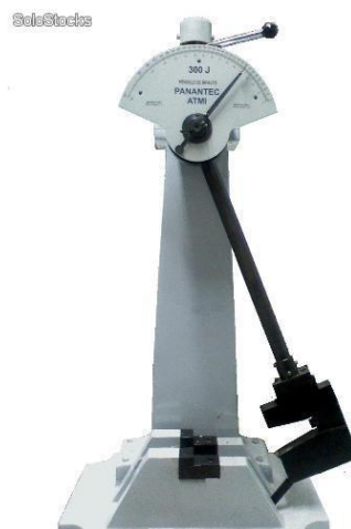
Figura 32 - Ensaio de Charpy [27]
