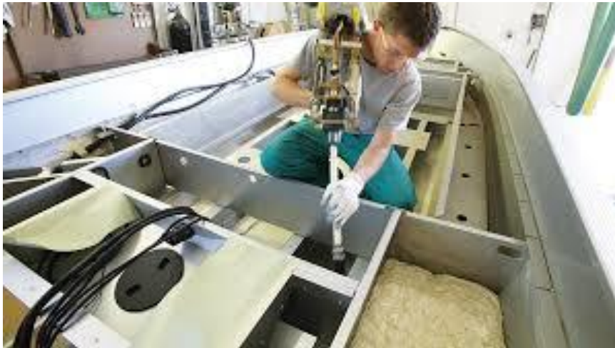
Figura 4 – Aplicação de adesivo num barco [10]
