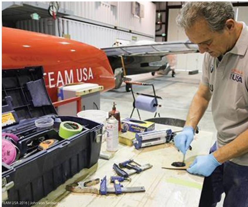
Figura 3 – Adesivo empregue num componente de avião [8]
