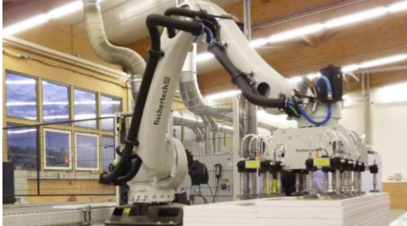
Figura 4.13: Manipulador KUKA a paletizar as placas de madeira [38].
