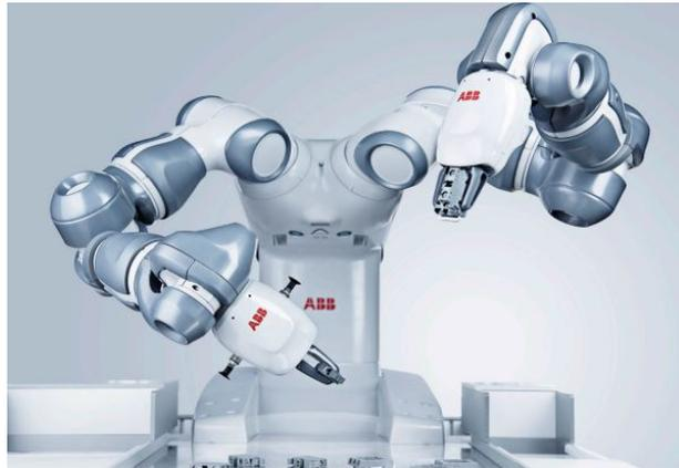
Figura 2.3: Robô colaborativo YuMi – IRB 14000 da ABB [8]
