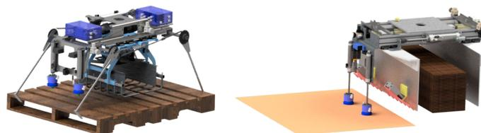
Figura 4.8: Atuadores finais com dois tipos de sistemas de manipulação [31].
