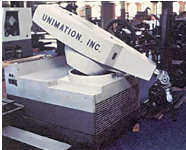
Figura 2.2: Unimate a realizar uma operação de manipulação [2].
