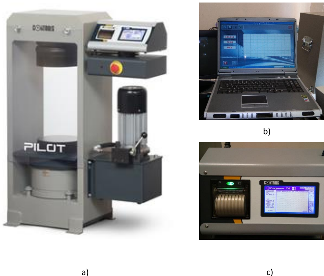
Figura 5.5 Ensaios de compressão simples: a) Controls Pilot C50-56 utilizada nos ensaios (LGMC|ISEP); b) Aspeto do equipamento de controlo durante ensaio; c) Aspeto da consola digital e impressora da prensa de ensaio.
