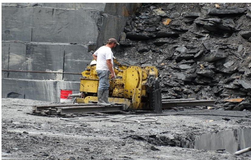
Figura 2.6 Corte de ardósia com lâmina com corrente de pastilhas diamantadas (ELV, do autor).
