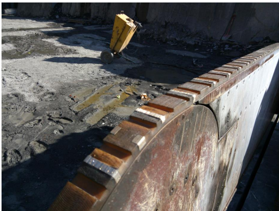
Figura 2.12 Braço de máquina Korfman de corte por corrente de pastilhas (ELV – autor).
