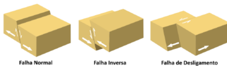
Figura 3.4 Tipologias de falha existentes.
