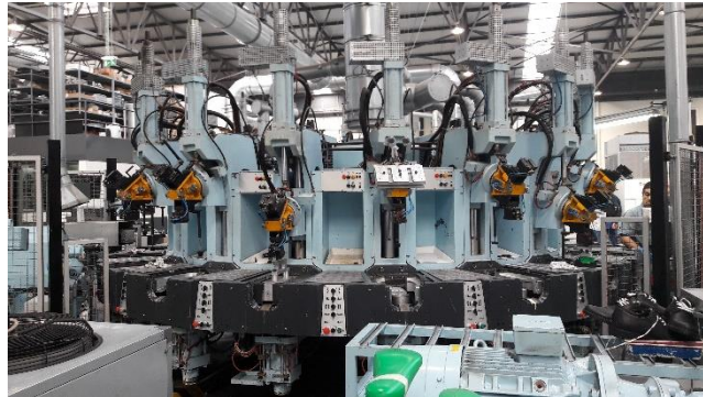
Figura 19- M quina injetora de PU (18 esta es)
