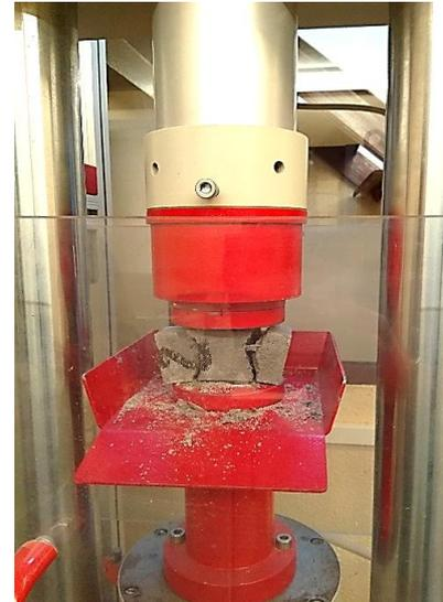
Figura 90 - Rotura do provete no ensaio à compressão.
