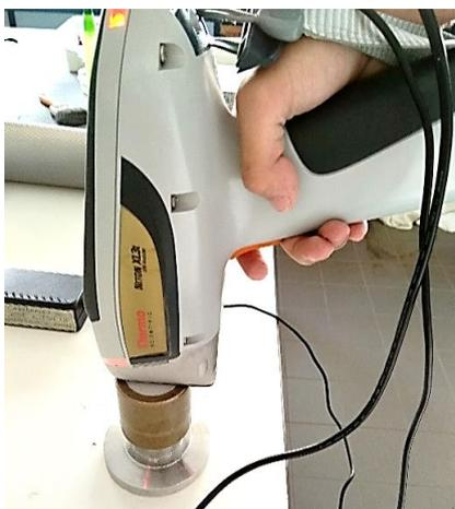
**Figura 96** – Análise química das pastilhas antes do processo de sinterização.
