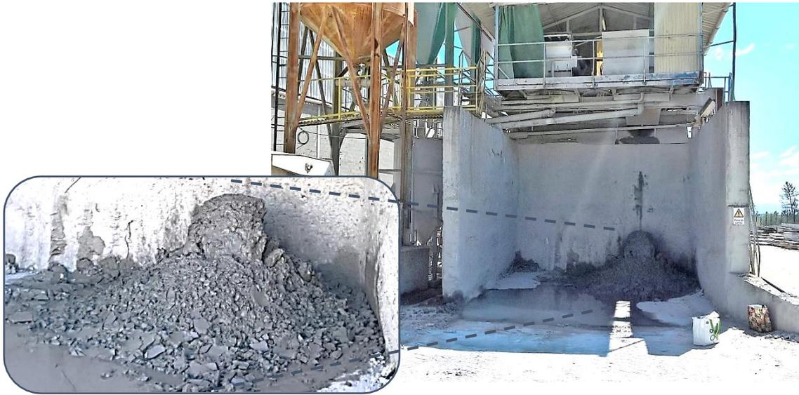
**Figura 38** - Local de amostragem 3 – Filtro Prensa com lamas da serragem de granitos.
