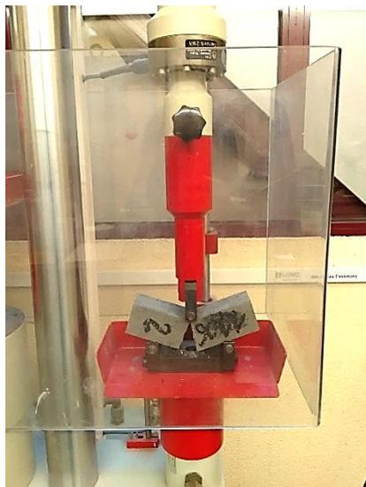
Figura 87 – Rotura do provete no ensaio de resistência à flexão.
