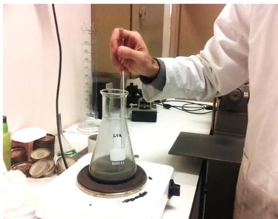
**Figura 50** - Aquecimento e agitação da amostra com hexametáfosfato de sódio.
