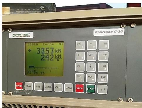
**Figura 88** - Painel eletrónico do equipamento de compressão.
