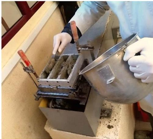
**Figura 77** – Colocação da argamassa no molde
