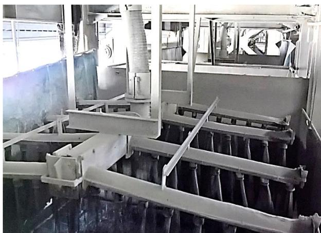
**Figura 18** - Sistema de chuveiros do engenho multilâminas.
