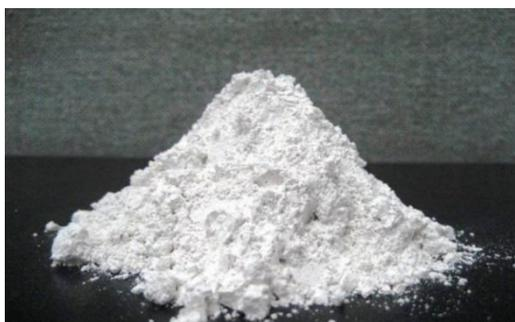
**Figura 23** - Cal hidratada utilizada na calda abrasiva.
