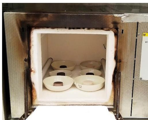
**Figura 98** – Pastilhas na mufla após o ensaio de sinterização.
