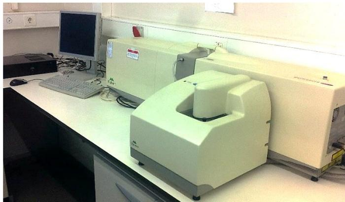
Figura 51 - Granulômetro laser - Malvern Hydro 2000G.
