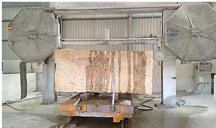
**Figura 29** - Máquina de Fio diamantado Micheletti.
