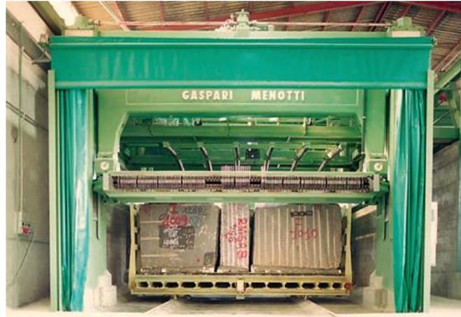
**Figura 16** - Engenho multilâminas Gaspari Menotti JM 6000.
