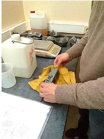
**Figura 93** - Limpeza superficial do provete.
