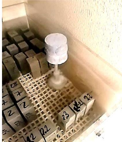
Figura 56 - Voluminímetro no tanque de água.
