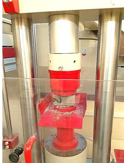
Figura 89 - Colocação do provete na prensa para ensaio à compressão.
