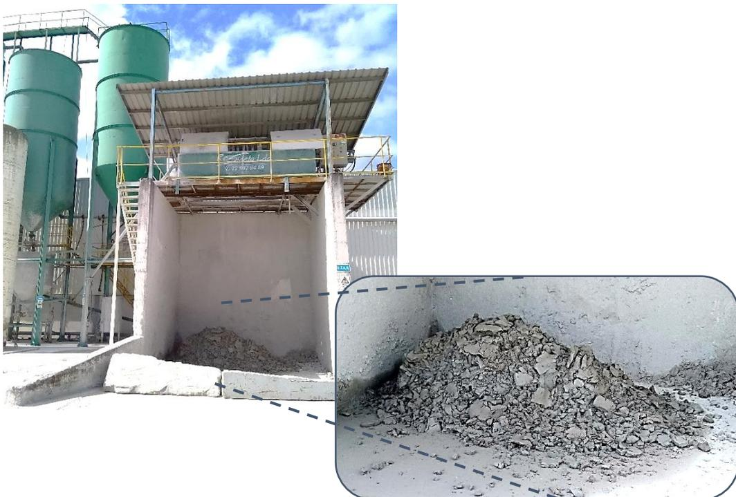
**Figura 39** - Local de amostragem 4 – Filtro prensa com lamas do corte de mármore e calcários.
