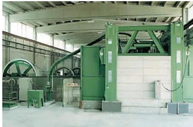
**Figura 17** - Vista lateral do engenho (pormenor do volante e biela).
