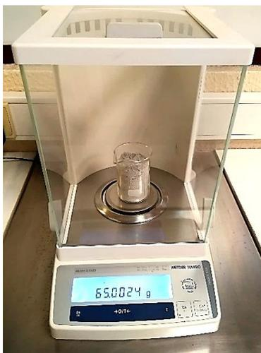
**Figura 54** - Pesagem do provete de ensaio.
