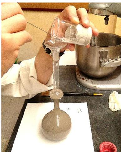
**Figura 55** - Introdução da amostra no voluminímetro.
