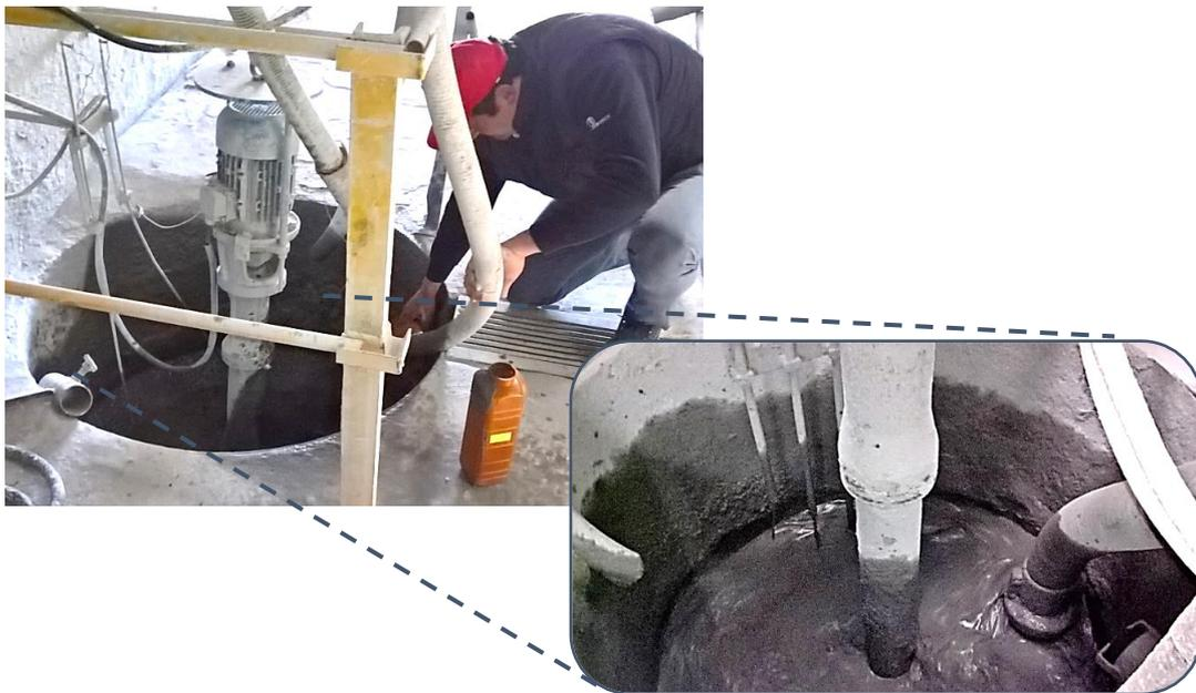
Figura 37 - Local de recolha de amostras 2 – poço de expurgo da calda abrasiva.
