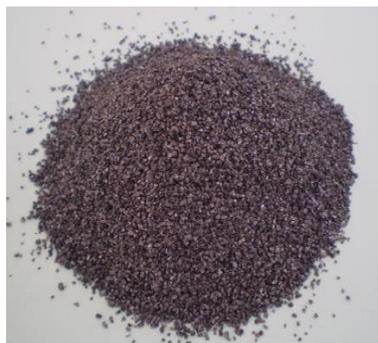
**Figura 22** - Granalha de aço angular.
