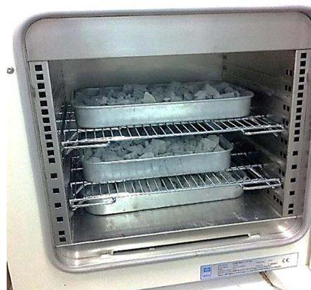
**Figura 42** – Material seco na estufa.
