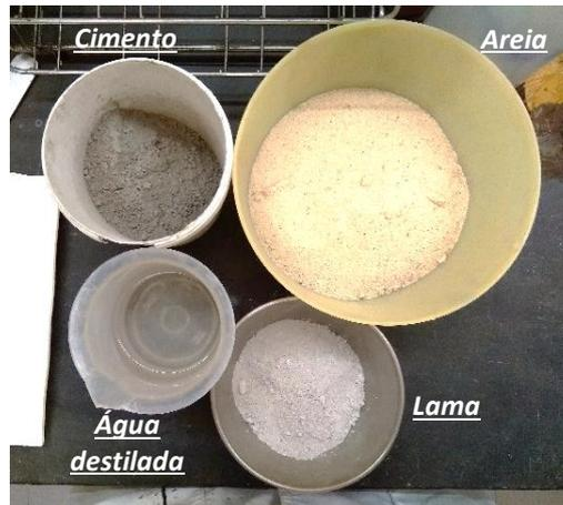
**Figura 75** – Materiais utilizados na amassadura.
