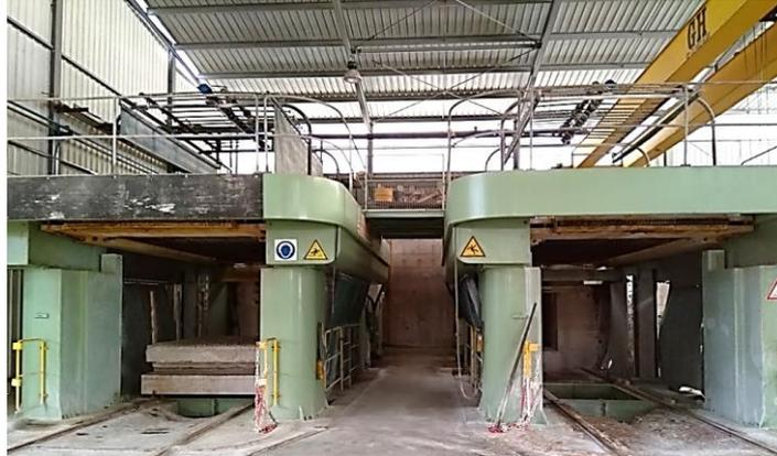
**Figura 24** - Engenho de lâminas diamantadas - modelo SFERA 80/800.
