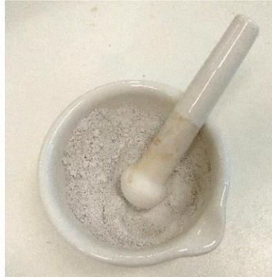
**Figura 43** - Pilão e almofariz para desagregação das amostras.
