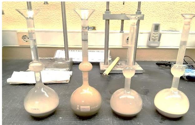
Figura 57 - Voluminímetro com as quatro amostras de lama.
