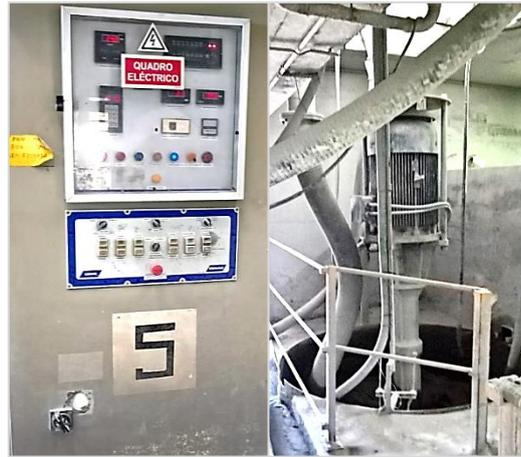
Figura 19 - Sistema de controlo do engenho (à esquerda) e poço principal de mistura (à direita).
