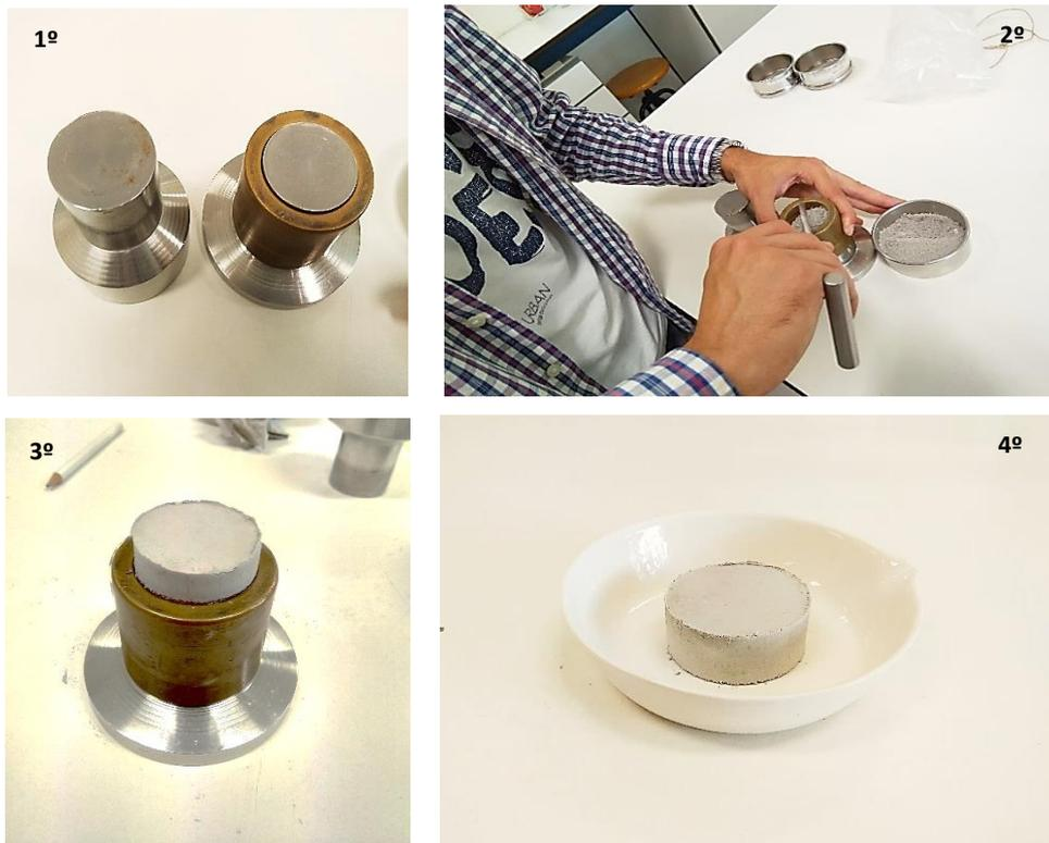
Figura 95 – Preparação da pastilha: 1º) Molde/Prensa Metálica; 2º e 3º) Execução da pastilha; 4º) Pastilha para ensaio
