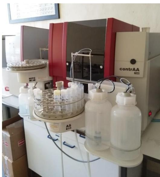
**Figura 70** - Espectrofotómetro de absorção atómica *ContrAA700* da *Analytik Jena*.
