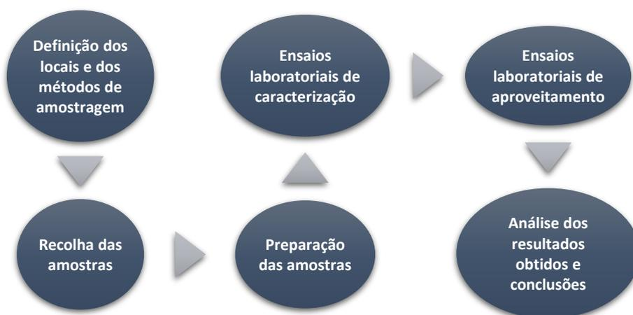
**Figura 34** - Metodologia utilizada no estudo de caracterização e aproveitamento das lamas.
