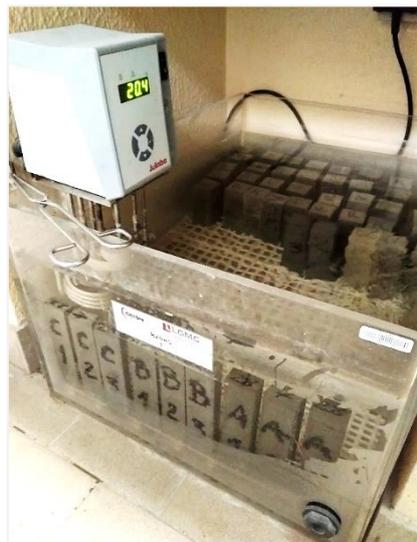
**Figura 81** – Provetes em hidratação no tanque com água.
