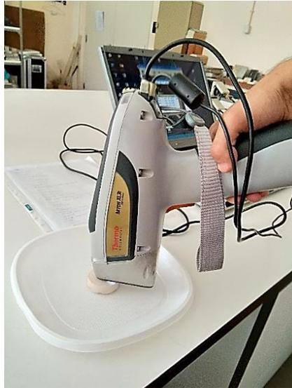
**Figura 99** - Análise química das pastilhas após o processo de sinterização.
