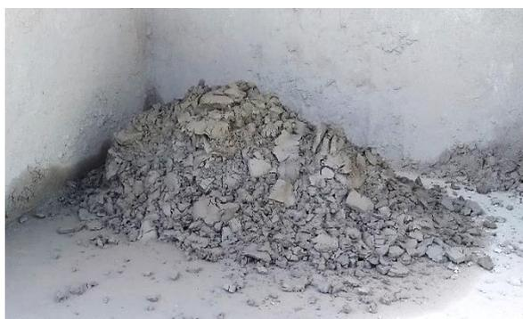
**Figura 32** - Lamas prensadas (bolos).
