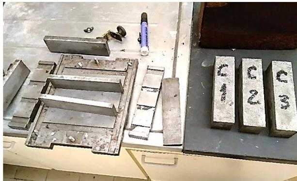
**Figura 80** – Desmoldagem e identificação dos provetes.
