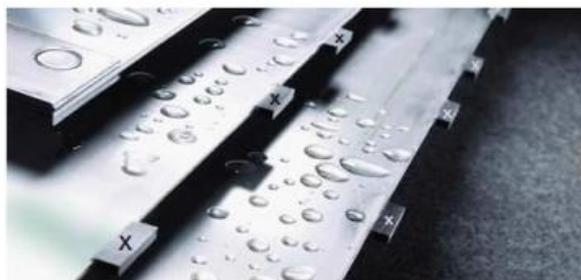
**Figura 26** - Pormenor do segmento diamantado (x) incrustado na lâmina.
