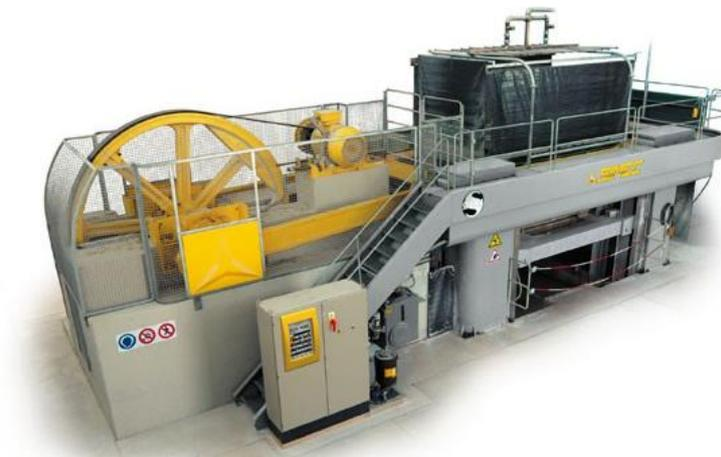
**Figura 25** - Vista lateral do Engenho - modelo SFERA 80/800.
