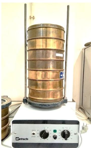
**Figura 47** - Equipamento de peneiração mecânica.
