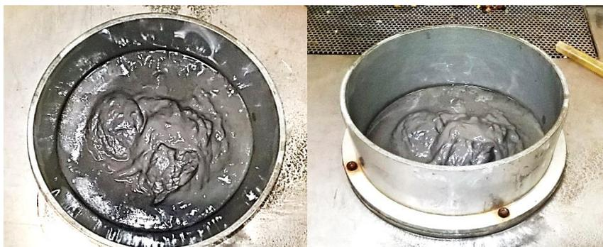
**Figura 40** – Preparação da amostra proveniente dos engenhos multilâminas.
