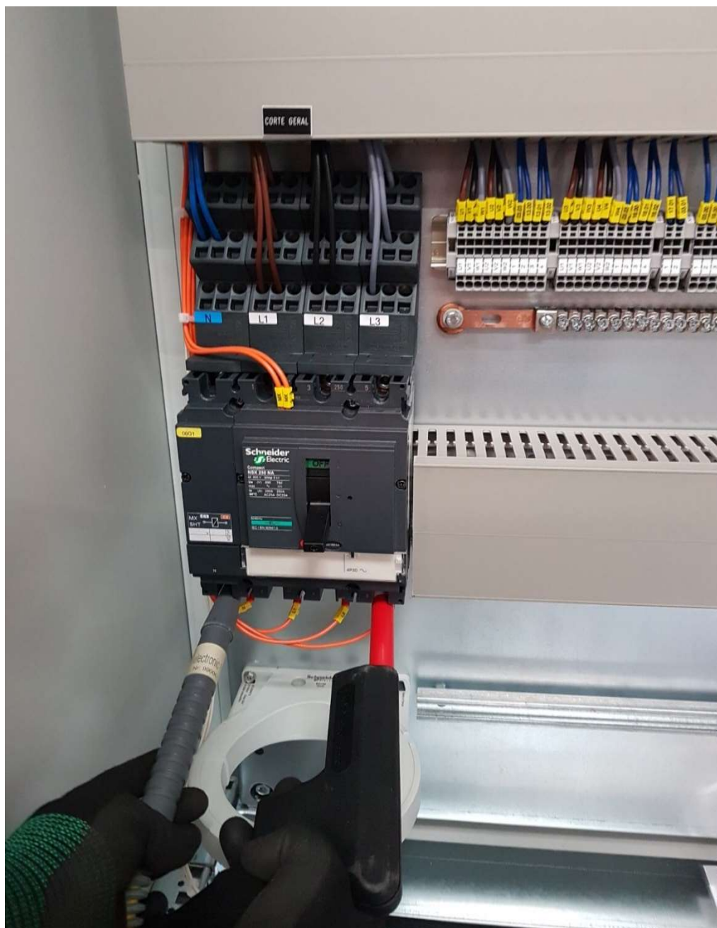
Figura 64 - Ponta de prova para o ensaio da rigidez dielétrica
