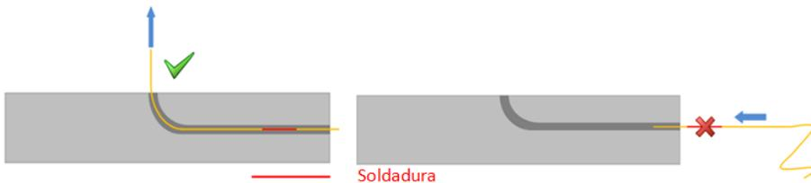
Figura 151. Esquema de introducción de fibras con soldaduras.
