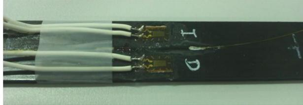
Figura 16. Comparativa dimensional entre galgas extensométricas y sensor FBG (ubicado entre las galgas).
