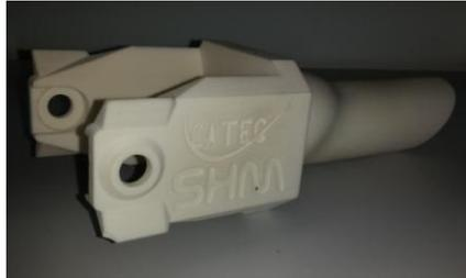
Figura 85. Mango de la herramienta de posicionado de fibra óptica.
