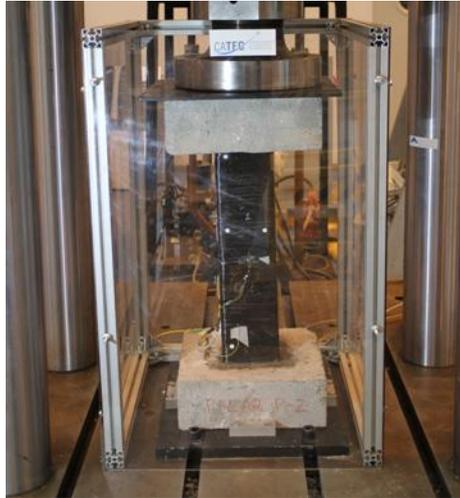
Figura 121. Ensayo de pilar de hormigón armado reforzados con CFRP.
