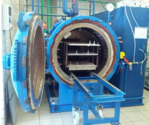
Figura 94. Autoclave empleada para el curado del material compuesto Z19.732.
