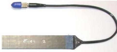
Figura 31. Probeta con salida de fibra óptica por el borde con protección de caucho [FRO 2006].
