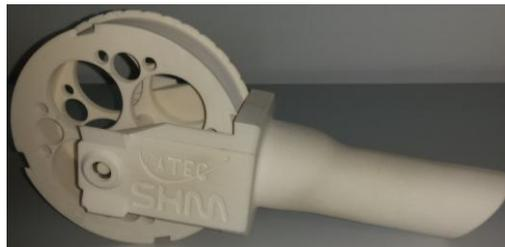
Figura 88. Herramienta de posicionado de fibra óptica.
