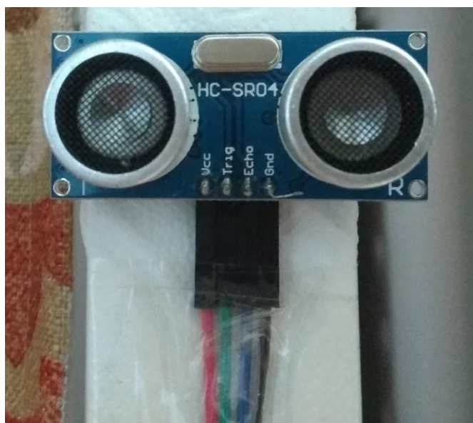
Ilustración 27 – Sensor de proximidad colocado transversalmente a la zona de paso, verticalmente
