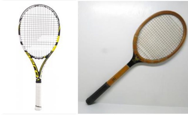
Figura 11 - Diferença construtiva entre uma raquete de tênis atual de compósito e uma antiga de madeira [Autor]
