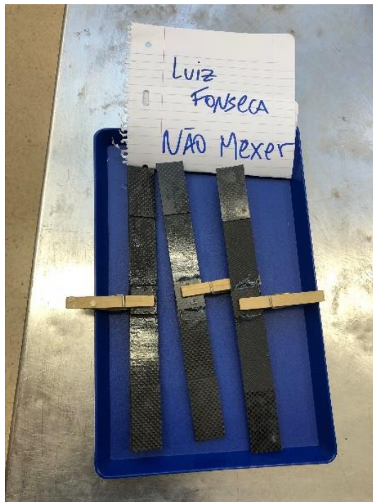
Figura 58 - ilustração da etapa final da colagem da reparação
