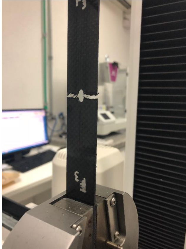
Figura 88 - Tipo de falha do material quando submetido até a rotura
