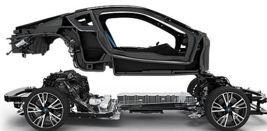
Figura 9 - Carroceria em fibra de carbono do BMW i8 [66]
