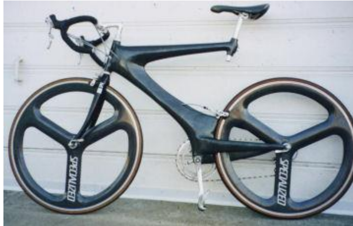
Figura 12 - Aplicação de Fibra de carbono em estruturas de bicicletas
