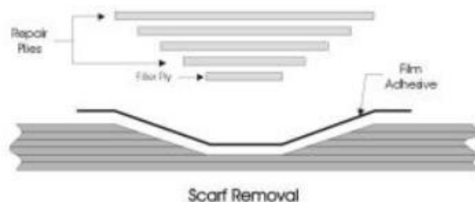
Figura 36 - Modelo em chanfro de reparo
