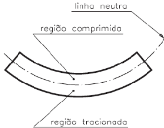
Figura 19 - Explicação de aplicação de flexão [55]
