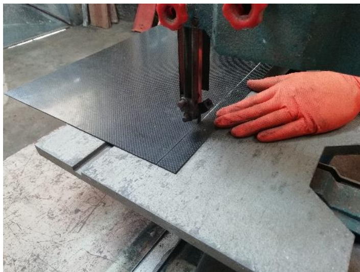
Figura 49 - Corte da placa nos formatos dos provetes
