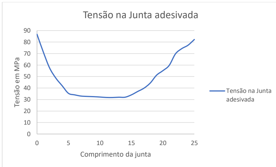
Figura 108 - Tensões longitudinais na região da junta colada
