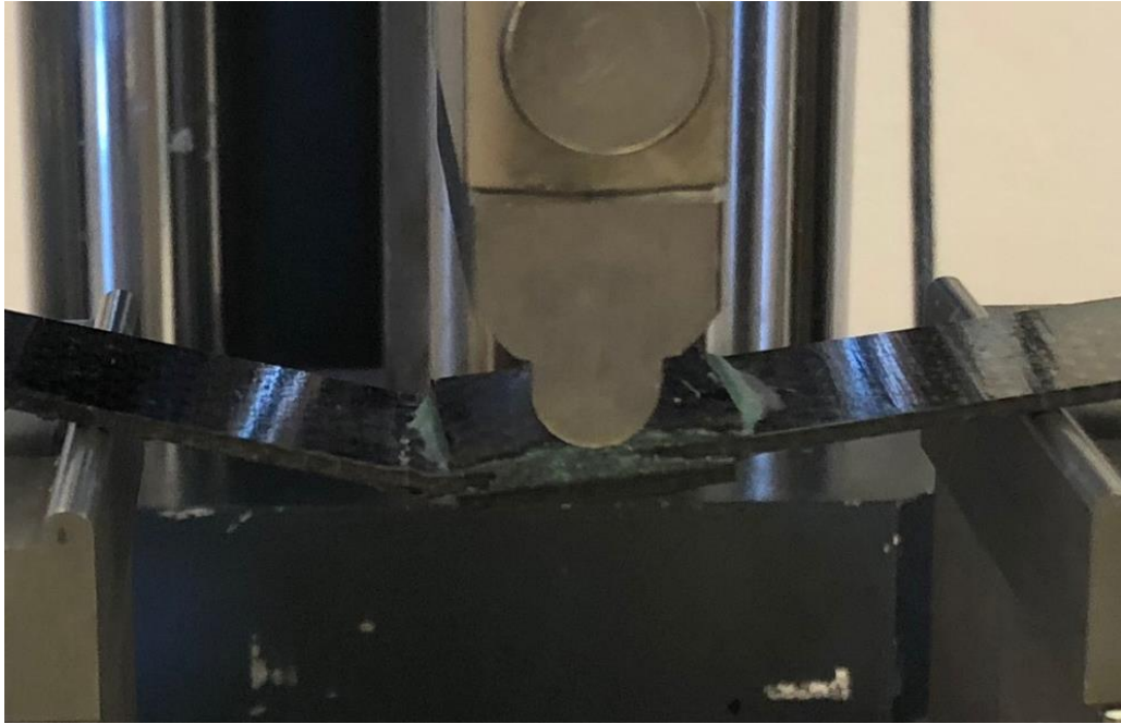
Figura 98 - Falha do material às beiras da reparação
