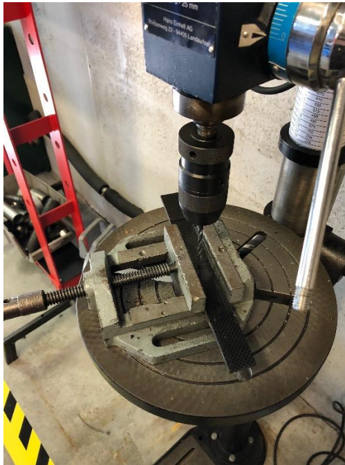
Figura 52 - Metodo de furação no provete
