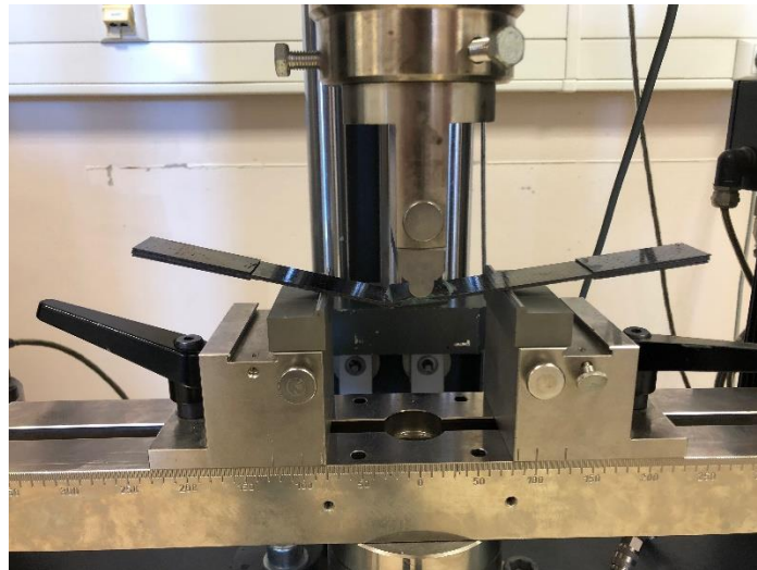
Figura 95 - Ensaio de flexão com provete reparado até a fratura
