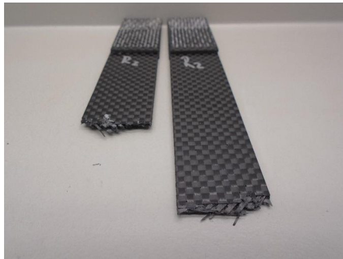
Figura 83 - Fratura no provete sem dano
