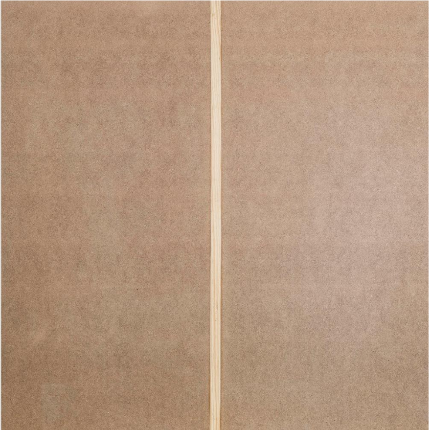
Figura 83 – Módulo da pista do manequim com guia central construída com ripa de perfil achatado.
