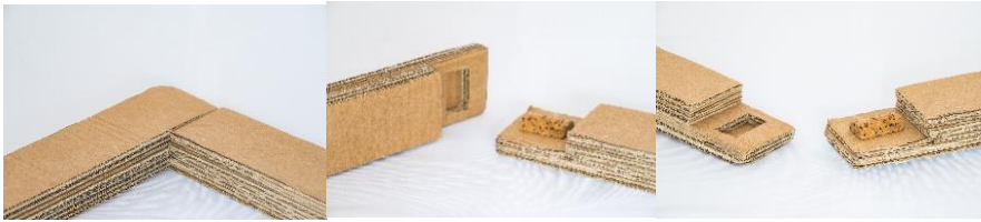
Figura 45 - Experiência 1, modelo de pormenor de ligação.
