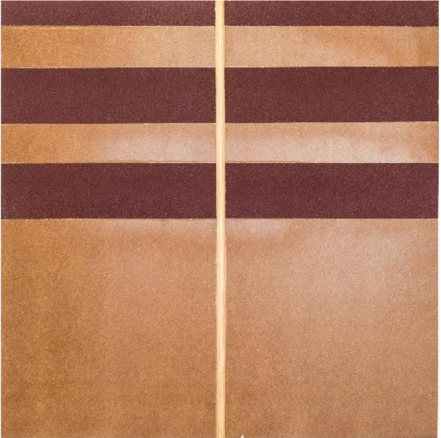
Figura 118 – Modelo final testado. Módulo com guia central e faixas de lixa alternada (vermelha).
