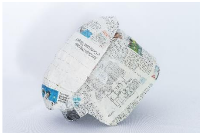
Fase 92 – Experiência nº 2: vista lateral, corte arredondado da abertura para entrada de ar, com grelha perpendicular e “concha” paralela à máscara.
