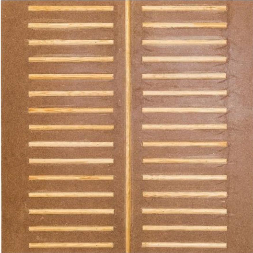
Figura 119 – Modelo final testado. Módulo com guia central e ripas perpendiculares de perfil arredondado.
