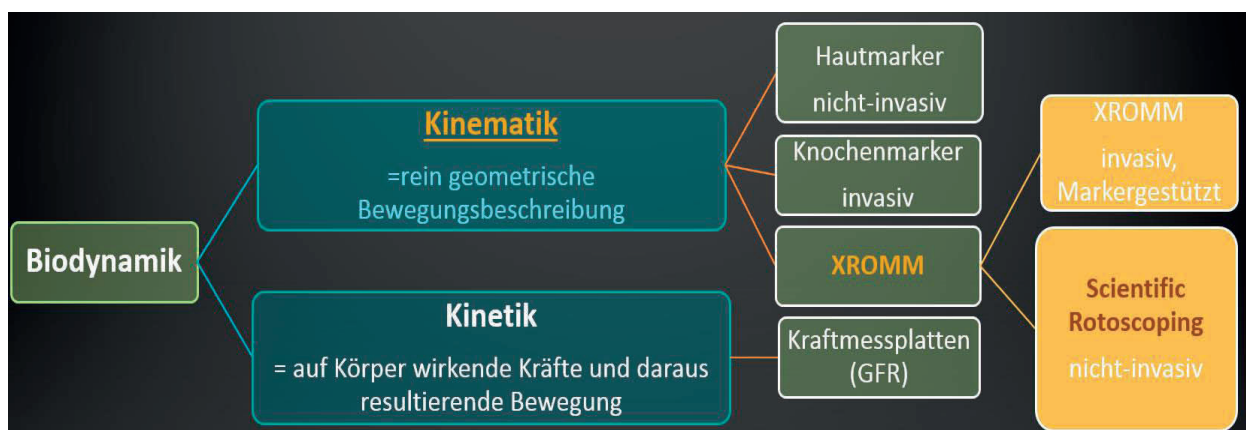
Abb. 4: Übersicht über die wichtigsten Ganganalysemethoden. Die Bewegungsmessung der Ganganalyse lassen sich in die Kinematik und die Kinetik untergliedern.
