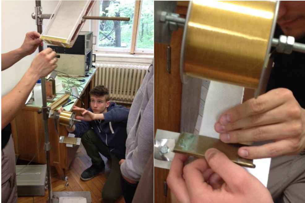
27. ábra Felfüggesztett test fejtí ki az állandó húzóerőt
