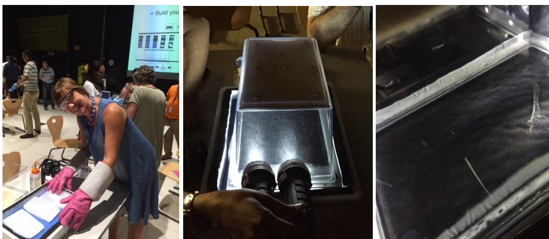
8. ábra A ködkamra építése és nyomvonalak
