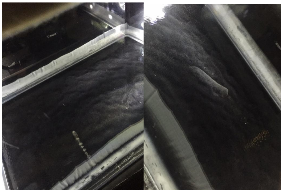
48. ábra Elektron nyoma a ködkamrában
