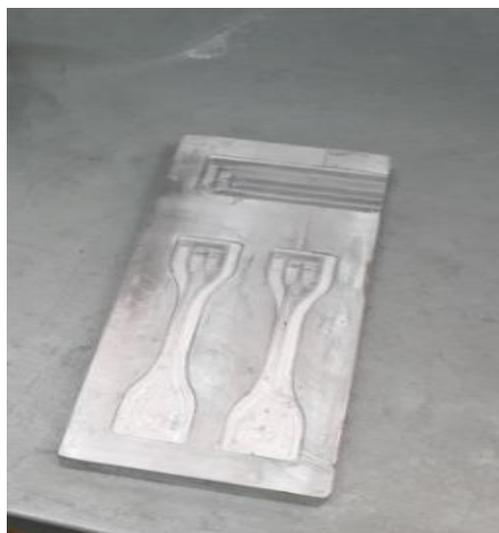
Figura 30-Molde em aço para os provetes de ensaio.
